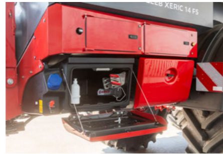
Просторе відділення для зберігання з інструментами, вагою та літровою міркою для калібрування.
