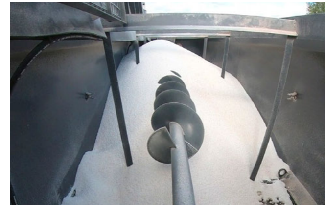
Розподільний шнек для оптимального спорожнення резервуара для добрив
