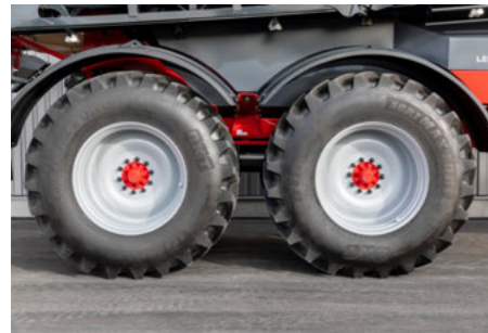
Шини до Ø 2,19 м для максимальної площі контакту з ґрунтом.
