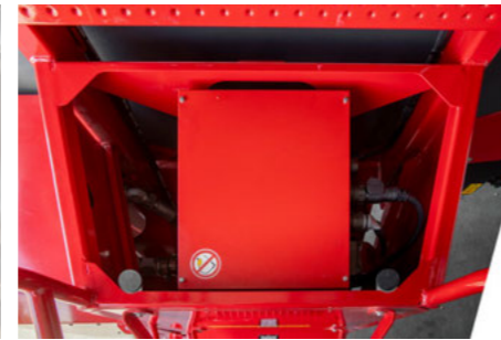
Безпечно розташування центральної електрики на платформі машини
