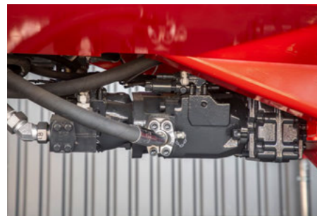
Потужний подвійний аксіально-поршневий насос
