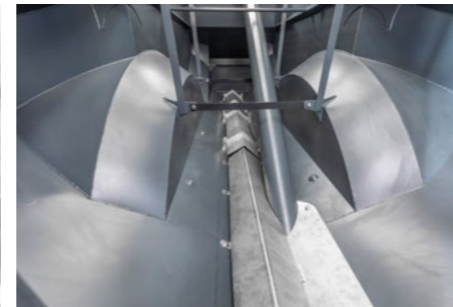
Внутрішнє облаштування резервуара з жолобом і підйомним шнеком
