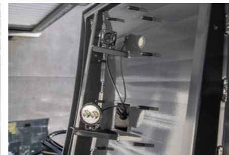
Внутрішнє освітлення бака з опційною камерою для контролю завантаження та рівня заповнення
