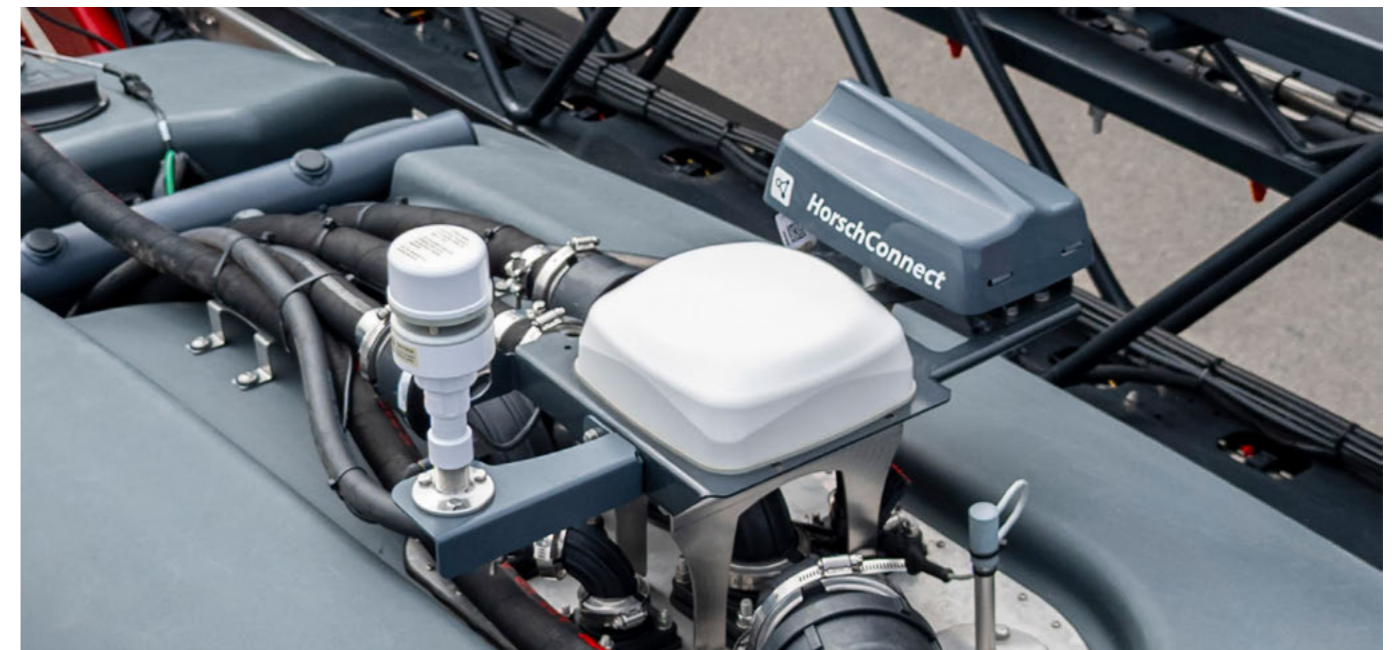
Цифрове з'єднання з HorschConnect, GPS та метеостанцією для оптимального пристосування до поточних умов навколишнього середовища
