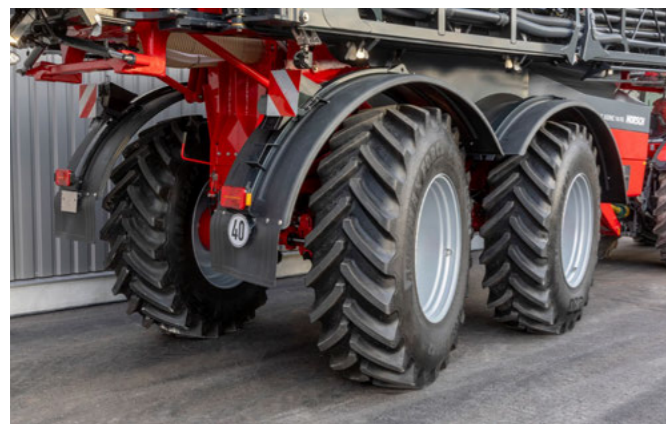
Активне керування обома осями з кутом повороту коліс до 28° для максимального збереження рослин
