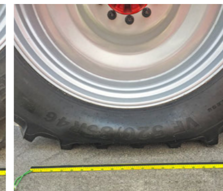
ATP Control — більша площа контакту із тиском у шинах 1,0 бар
