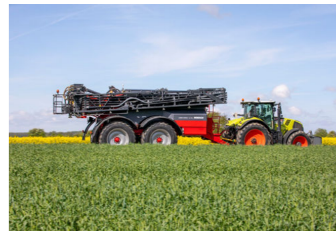
Гідравлічна підвіска та поворотний кулак з кутлом повороту до 28° для високого комфорту їзди та максимального збереження культур.
