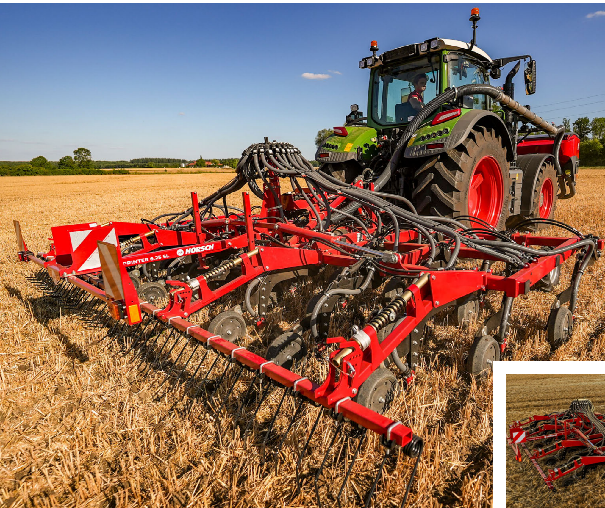
3-gerendelyes felépítés a maximális átteresztőképességért
