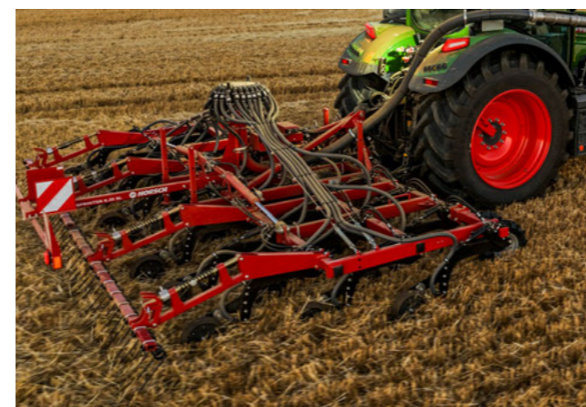
3-gerendelyes felépítés a maximális átteresztőképességért
