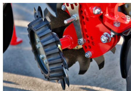
Opcionális rögtelők, úszó beállítás mélységtartással
