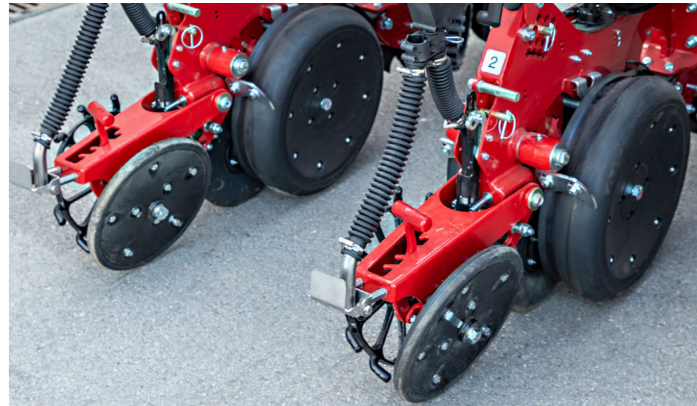
Mikrogranulátum egység soronként, mindkét alkalmazási ponton használható
