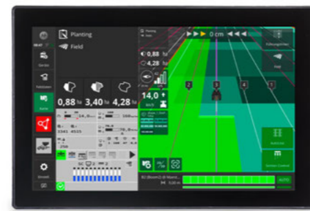
Az szemenkénti vetéstechnikával és a HORSCH AutoLine segítségével a művelőutak teljesen rugalmasan és a haladási iránytól függetlenül, GPS-támogatással vehetők
