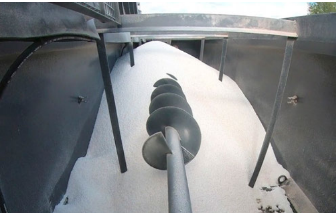
Feltöltőcsiga a műtrágyatartály optimális kiürítéséhez
