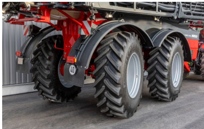
Aktív kormányzás akár 28°-os kormányzási szöggel a maximális növényvédelem érdekében
