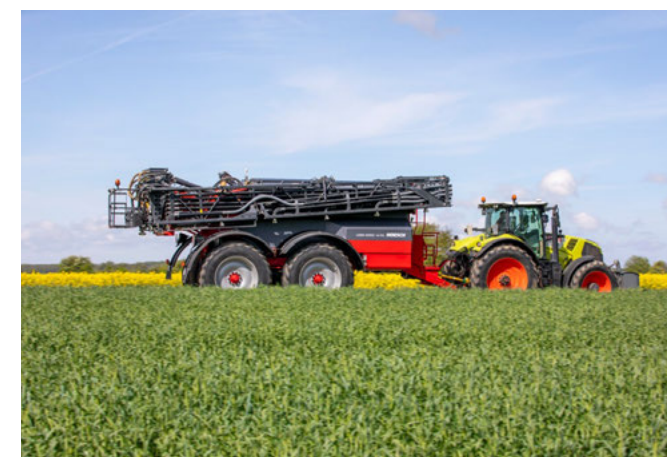
Hidraulikus rugózás és tengelycsonk-kormányzás akár 28°-os kormányzási szöggel a magas vezetési kényelem és a maximális növénykimelés érdekében
