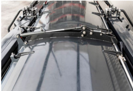
Hidraulikus tartályfedél és reteszelés
