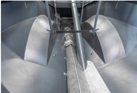
Tartály belső kialakítása vályú- és emelőcsigával
