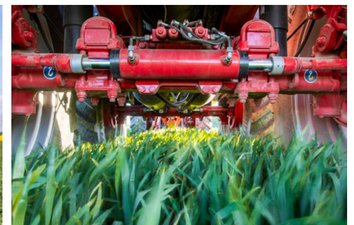
Maximális hasmagasság 2,19 m átmérőjű abroncsokkal
