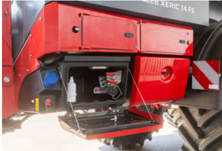
Tágas tárolórekesz szerszámokkal, mérleggel és literes mérőedénnyel a kalibráláshoz
