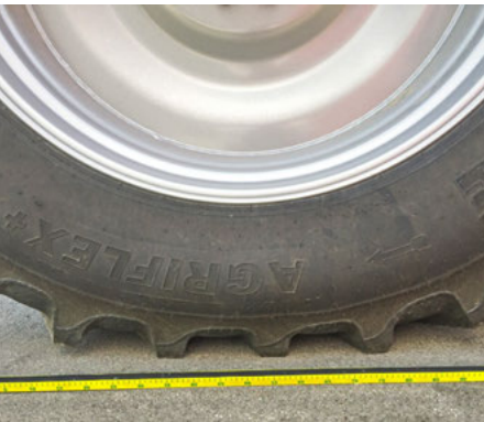
ATP Control – könnyed futás 2,3 bar guminyomásnál
