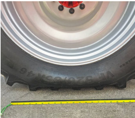
ATP Control - megnövelt érintkezési felület 1,0 bar abroncsnyomásnál
