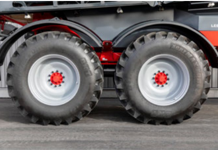
Gumiabroncsok Ø 2,19 m-ig a maximális felfekvő felületért
