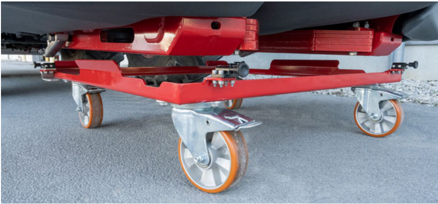
A masszív guruló-szállító kocsi megkönnyíti a fronttartály kezelését
