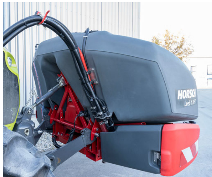
Leeb FT Pro tömlőtartóval és tömlőelhelyezéssel
