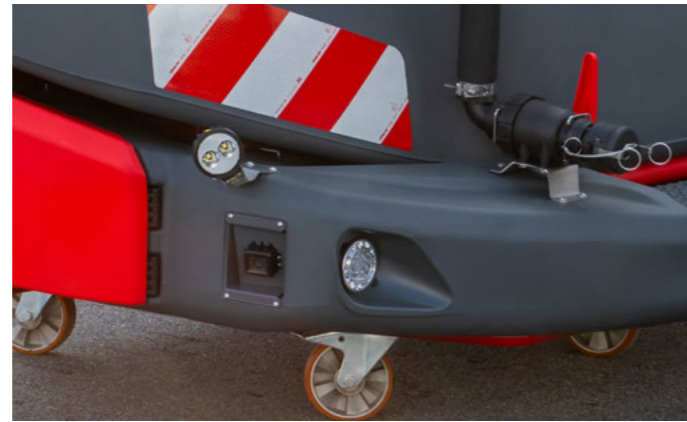
LED munkalámpák a szórókeret előterének megvilágítására
