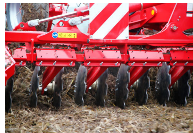
Széles tárcsacsapágyazás a vázon a tárcsák pontos vezetéséhez a talajban
