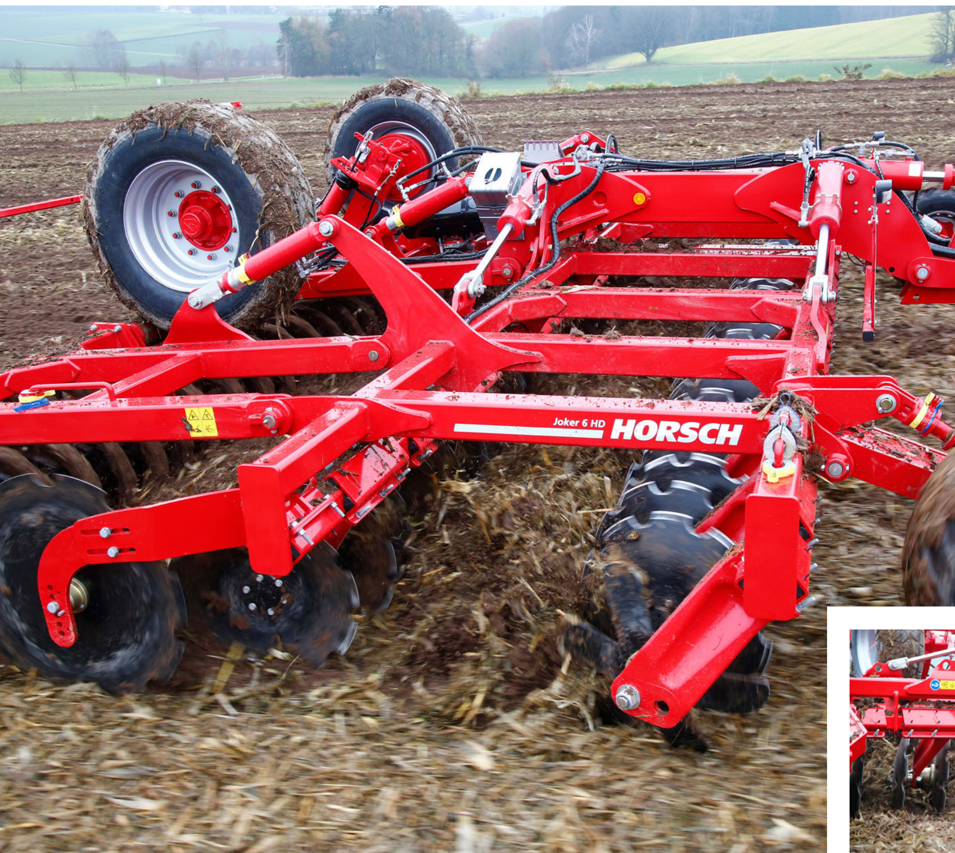
Széles tárcsacsapágyazás a vázon a tárcsák pontos vezetéséhez a talajban
