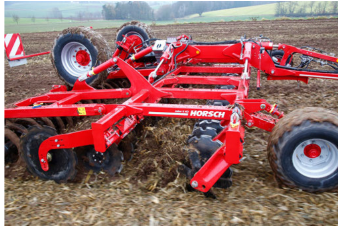
Nagy tárcsatávolság a maximális áteresztés érdekében a gépben
