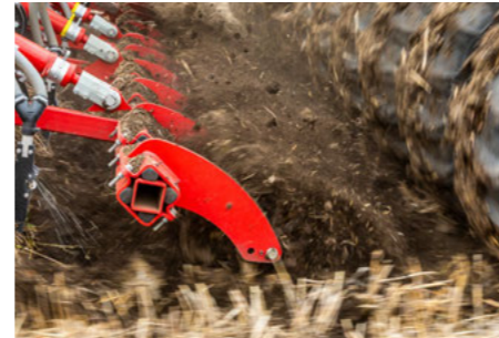
Finomföld előállítása a Krümel egyengetővel
