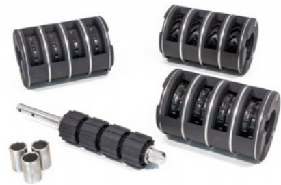
Aprómagdagoló készletek hagyományos adagolókhöz hatszögletű tengellyel
