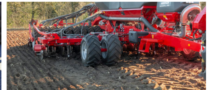
MiniDrill PPF – a harmadik komponens egy további horizonton juttatható ki
