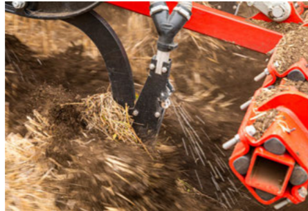
LD kapa/LD Plus kapa- Műtrágya kijuttatása a felső horizonton
