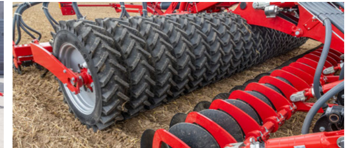
1-soros gumikerekes henger az egyenletes visszatömörítéshez
