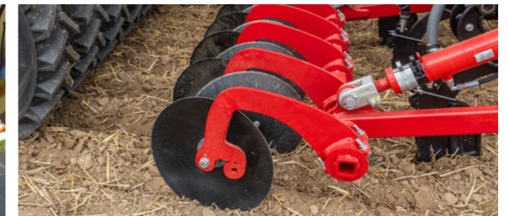
Tárcsás egyengetés a fellazított sáv biztonságos lezárásához
