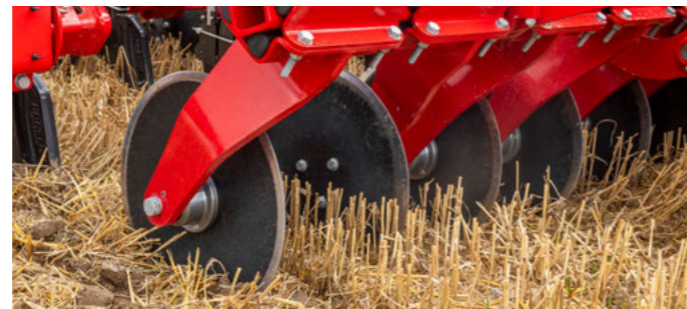
1-gerendelyes felépítés közvetlenül a kapák előtt
