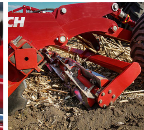
Ножовий коток з гідравлічним довантаженням як опція для додаткового подрібнення пожнивних решток.
