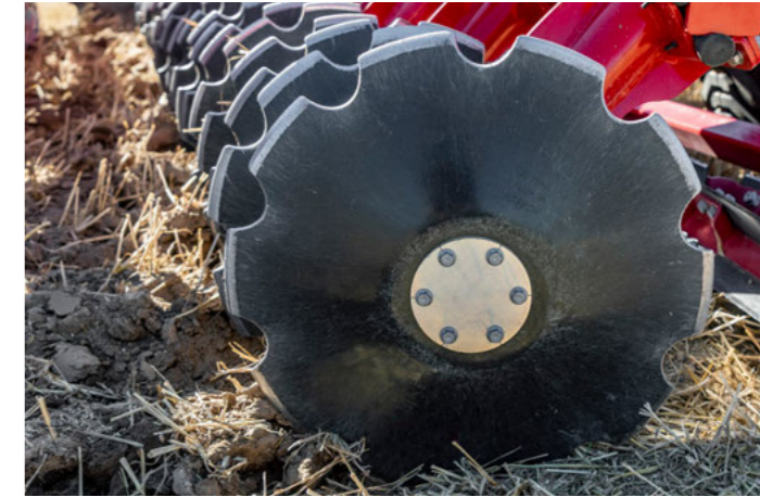
Диски із зубчастим профілем, Ø 68 см
