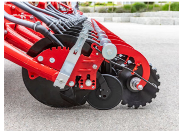
Az acél csillagkerék, finom talajt állít elő és lezárja a vetőbarázdát.
