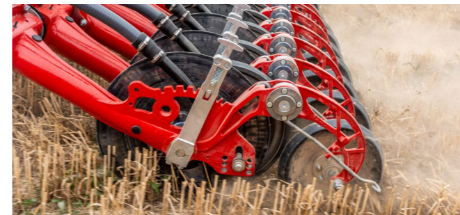
1-gerendelyes felépítés az egyenletes lehelyezés érdekében
