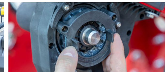
Dávkač mikrogranulátu s dávkovací vložkou
