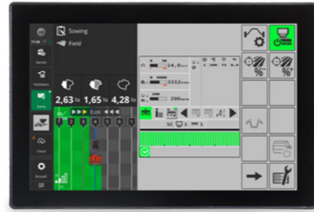
Zobrazením až 3 widgetů vedle hlavní pracovní obrazovky lze mít současně přehled o několika aplikacích
