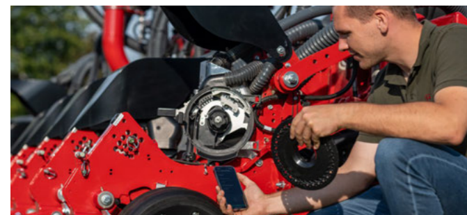
Aplikace HORSCH Assist s funkcí „Výběr dávkovacího kotouče“ pomáhá při výběru optimálního dávkovacího kotouče pro každé použití
