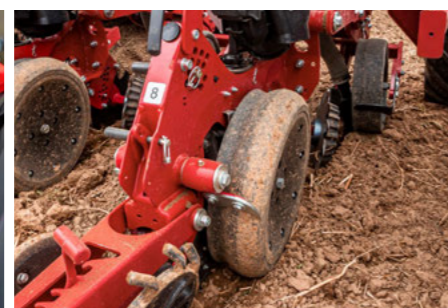
RID-kolo snižuje ztuhnutí půdy přímo u seťového lůžka při velmi tvrdých podmínkách a přímém setí
