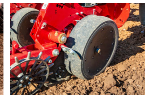
Standardní hloubkové vodící kolo pro normální podmínky
