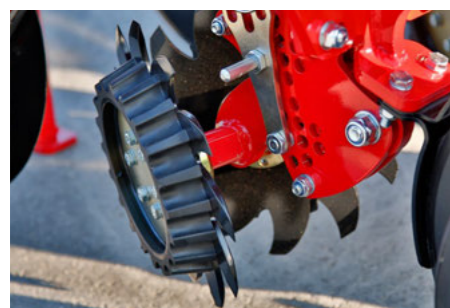
Volitelné hvězdicové odhrnovače rostlinných zbytků - plovoucí s hloubkovým vedením
