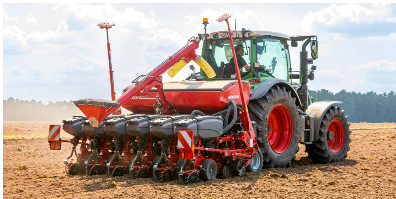
Maestro 6 TX se zásobníkem na hnojivo o objemu 1 300 l
