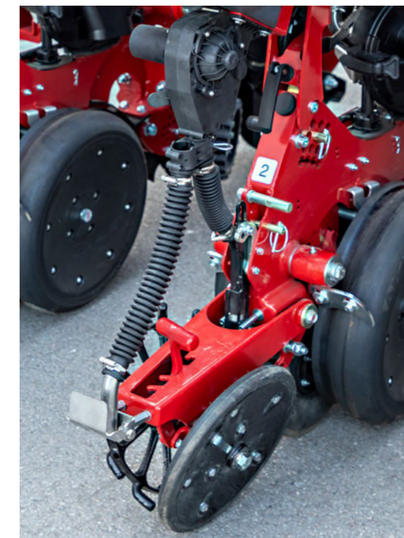
Aplikátor mikrogranulátu s oběma typy výpadů
