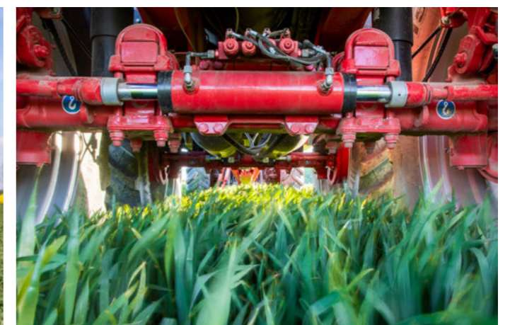
Maximální světlá výška s pneumatikami až do průměru 2,19 m
