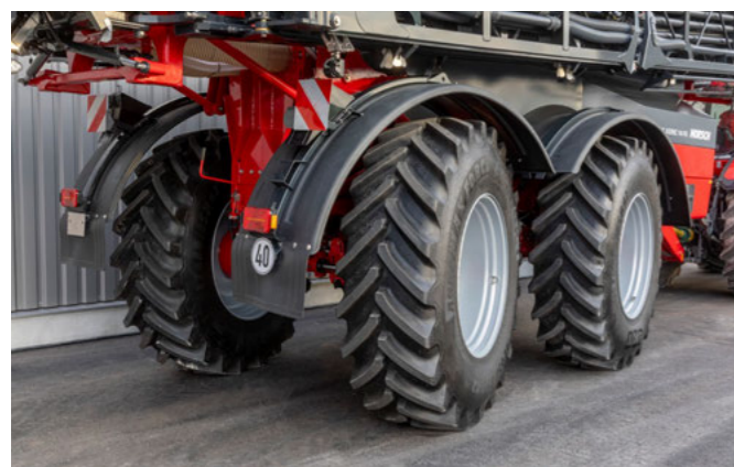
Aktivní řízení s úhlem natočení až 28° pro maximální ochranu rostlin
