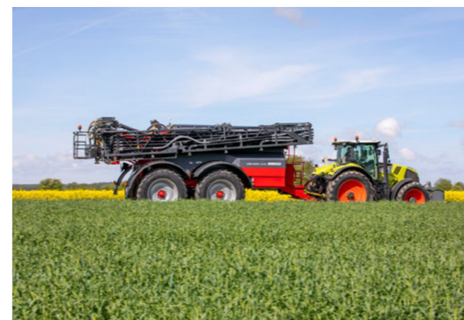
Hydraulické odpružení a řízení náprav s úhlem natočení až 28° pro vysoký jízdní komfort a maximální šetrnost k plodinám
