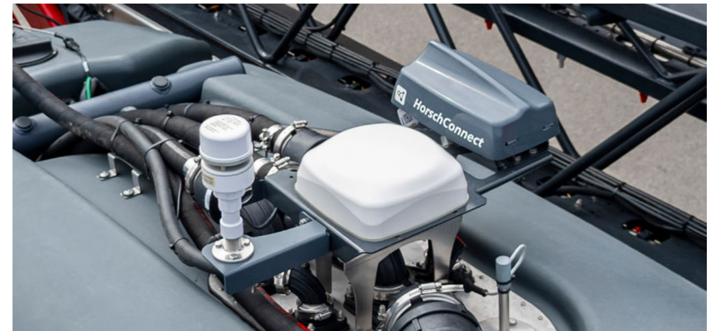
Digitální propojení s HorschConnect, GPS a meteorologickou stanicí pro optimální přizpůsobení aktuálním podmínkám prostředí
