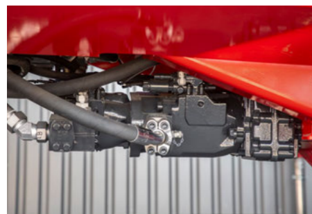
Výkonné dvojité axiální pístové čerpadlo
