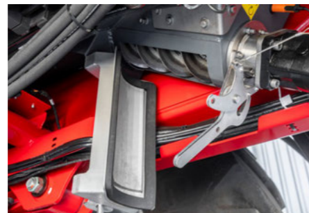
Vyprázdnění vynášecího šneku
