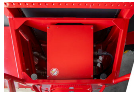
Bezpečné umístění centrální elektriky na podestě stroje
