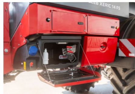
Prostorný úložný prostor s nářadím, váhou a litrovou odměrkou pro kalibraci
