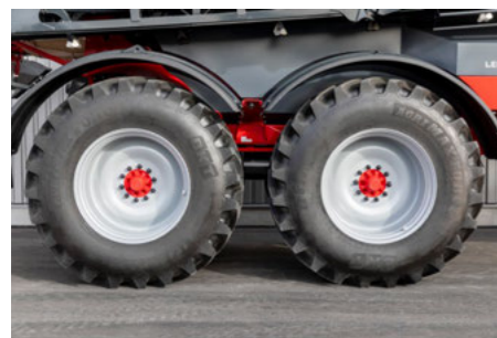
Pneumatiky až do \varnothing 2,19 m pro maximální styčnou plochu
