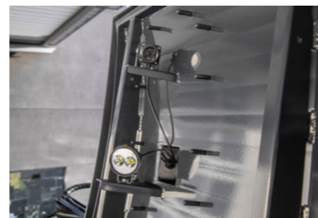
Osvětlení nádrže s volitelnou kamerou pro sledování plnění a úrovně naplnění
