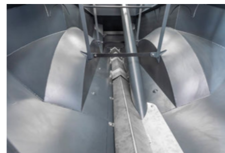
Vnitřní konstrukce zásobníku s průběžným a vynášecím šnekem
