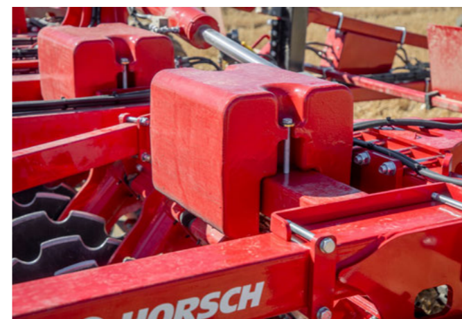
Přídavná závaží pro optimální rozložení hmotnosti a bezpečné pronikání do půdy
