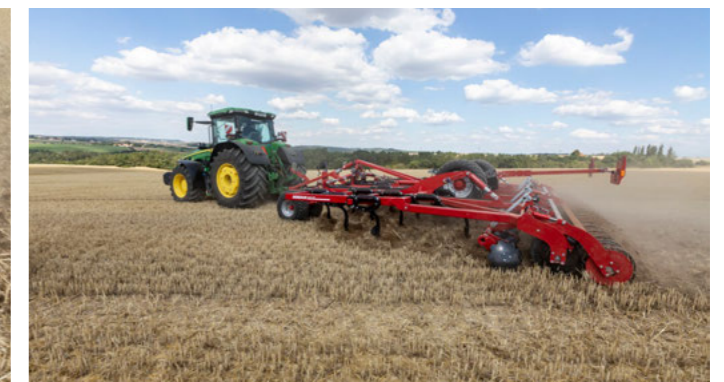
SteelFlex pěch s hydraulicky předepnutelným RingFlex pěchem
