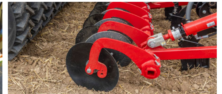
Diskové urovnání pro bezpečné uzavření nakypřené pásu
