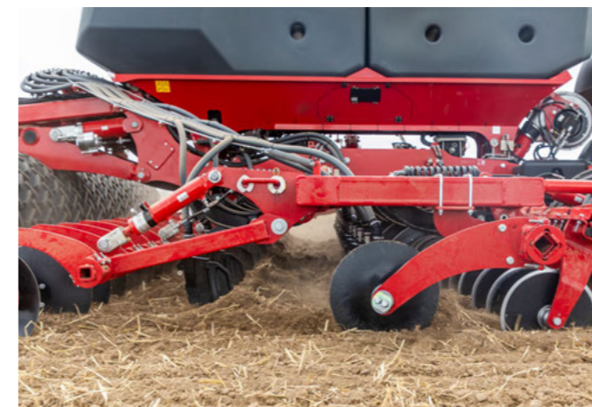
Zaměření na hluboké kypření s současným hnojením do depa
