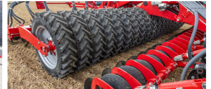
Jednořadý pneumatikový pěch pro rovnoměrné zpětné utužení
