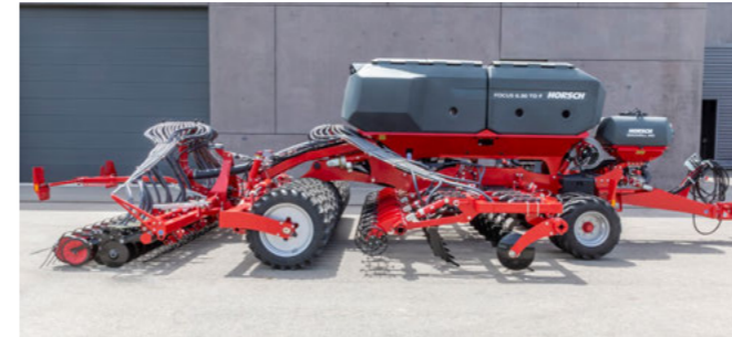
Pneumatikový pěch s velkým průměrem pneumatik pro lehký chod
