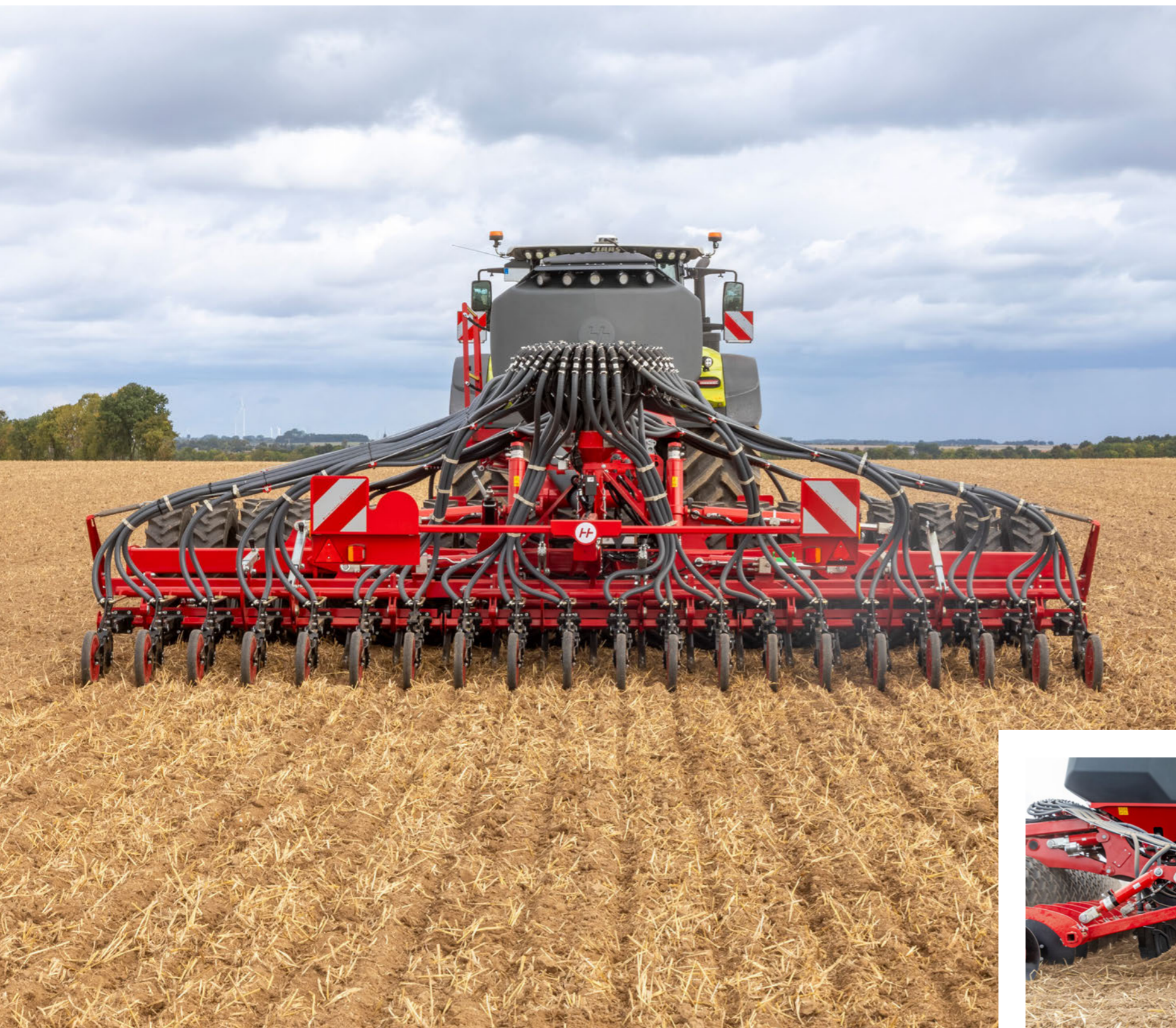
Zaměření na hluboké kypření s současným hnojením do depa
