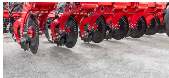
1-řadé uspořádání řezných kotoučů
