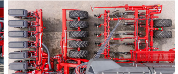
Pneumatikový pěch přímo za kypřicími slupicemi
