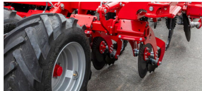
Předřezání přímo před každou slupicí
