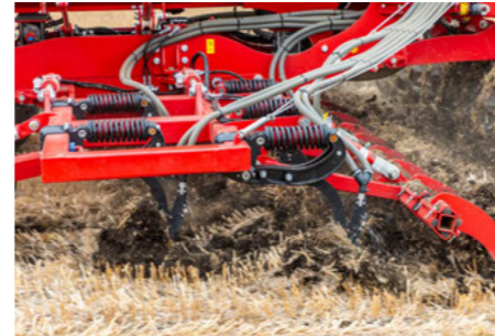
LD radlice/LD Plus radlice – Promíchání nakypřené oblasti
