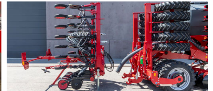
Snadná výměna secích lišt díky 3-bodovému závěsu
