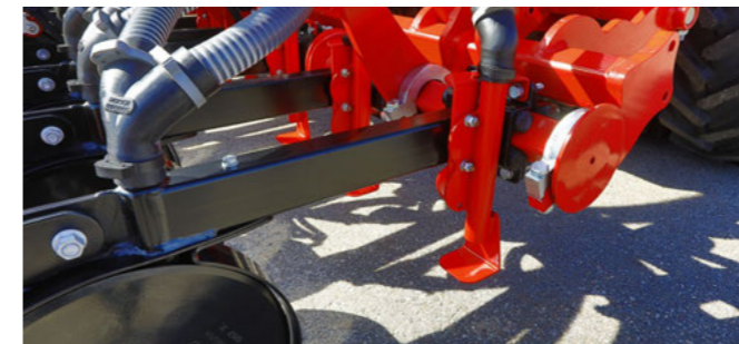
MiniDrill PPF s odrazovými plechy
