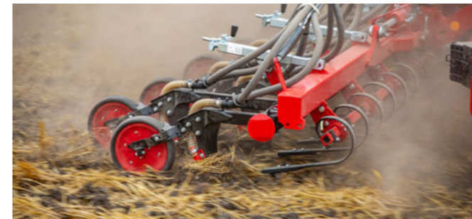
SeedFrame s TurboEdge radličkovými botkami
