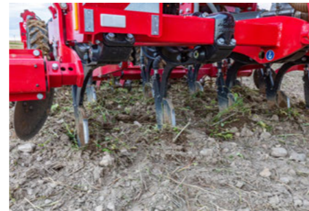
ULD radlička otevírá půdu a ukládá hnojivo
