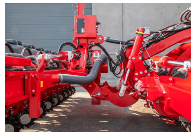
3-bodový závěs pro maximální flexibilitu
