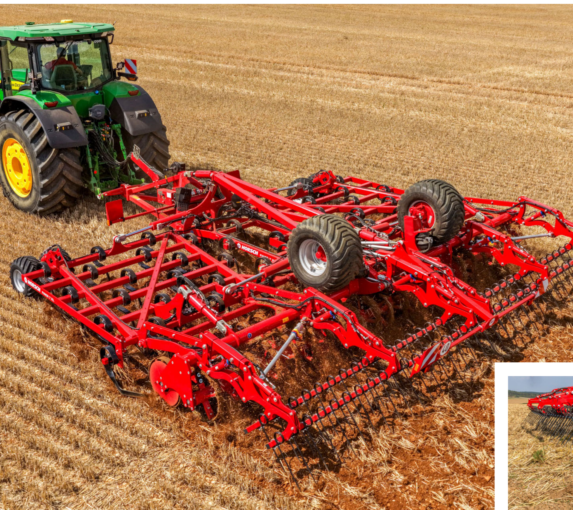
Prutové brány ukládají plevelé na povrch
