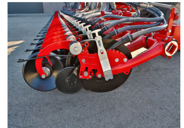
Perfektní upevnění osiva díky pryžovému záchytnému kolečku
