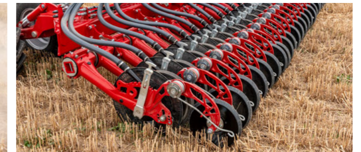
Jednokotoučová botka s individuálním hloubkovým vedením NarrowDisc
