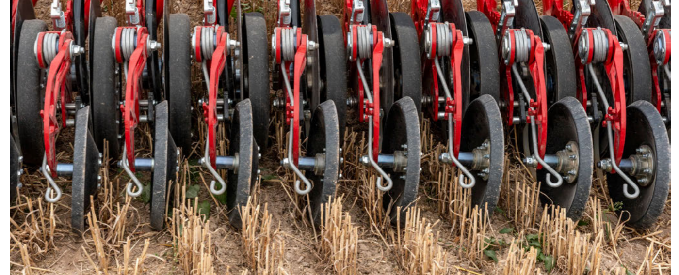
NarrowDisc jednokotoučové botky s roztečí řádků 20 cm
