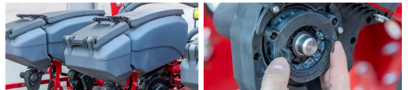
Contenedor de microgranulado en hilera con un volumen de 18 litros
