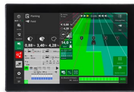
Con la técnica de siembra de grano individual y HORSCH AutoLine, se pueden sembrar los caminos de rodadura de manera completamente flexible e independiente de la dirección de conducción, con soporte GPS
