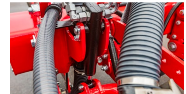
Cilindro hidráulico de presión de la reja
