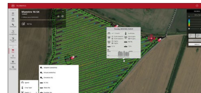
La transparencia como factor de éxito: datos relacionados con la posición de toda la información relevante, como mensajes de error, velocidad de trabajo o calidad de separación.
