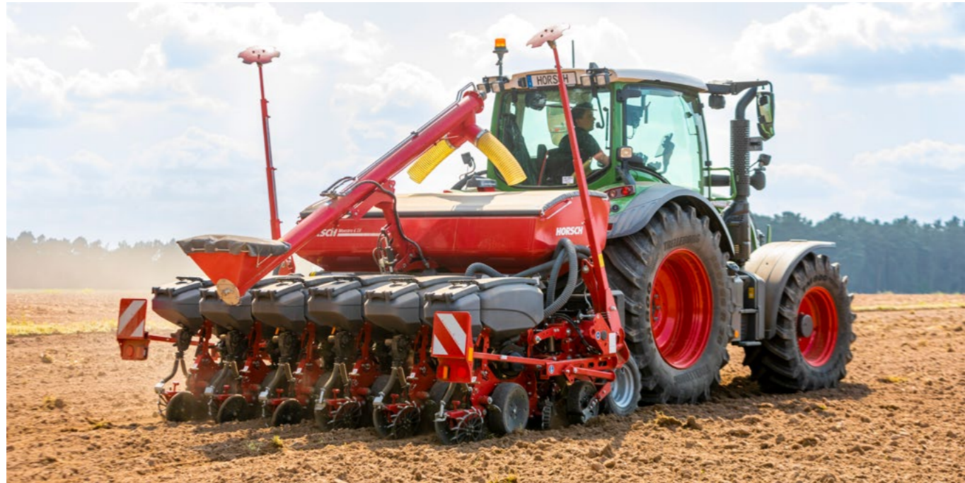
Maestro 6 TX con depósito de fertilizante de 1 300 l
