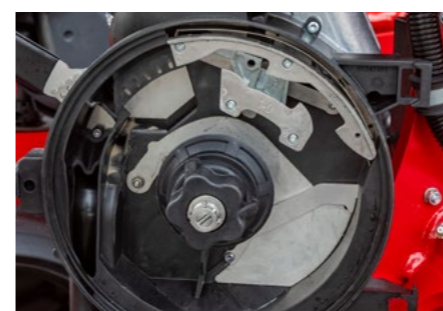
El singulador universal no necesita ser ajustado
