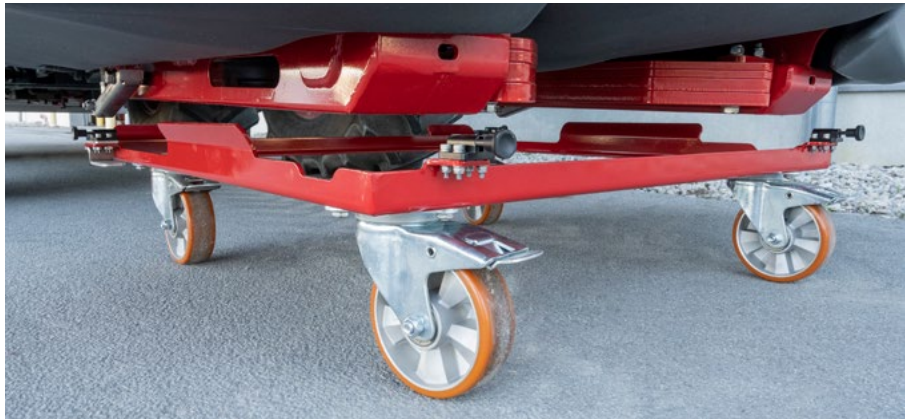
El robusto carro de maniobra facilita el manejo del tanque frontal
