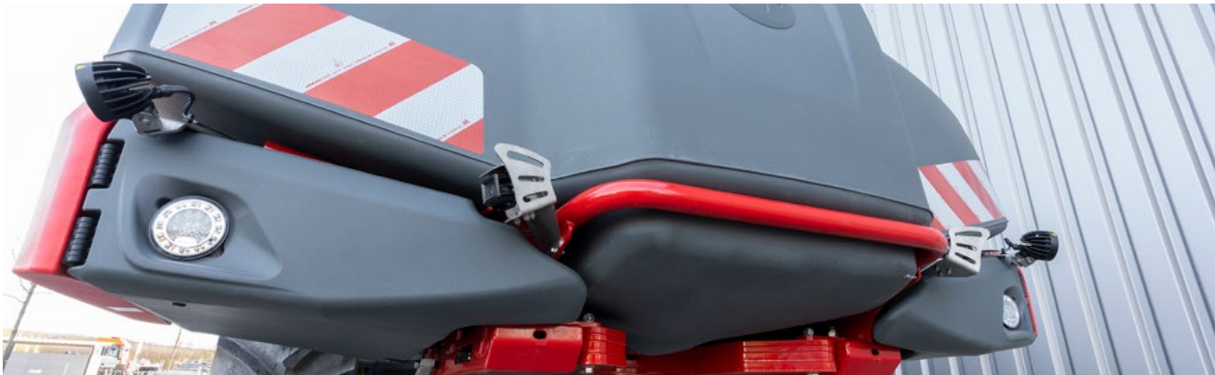
Sistema de cámaras para la supervisión del área de tráfico
