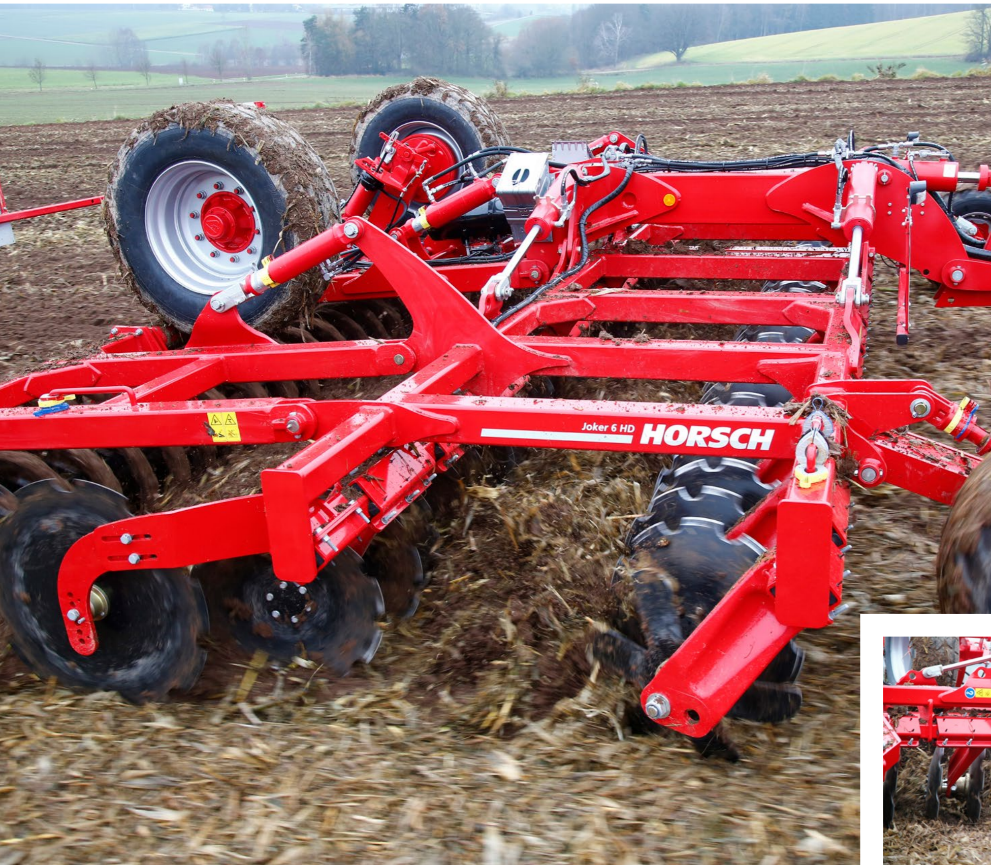
Amplio soporte de discos en el marco para una guía precisa de los discos en el suelo.
