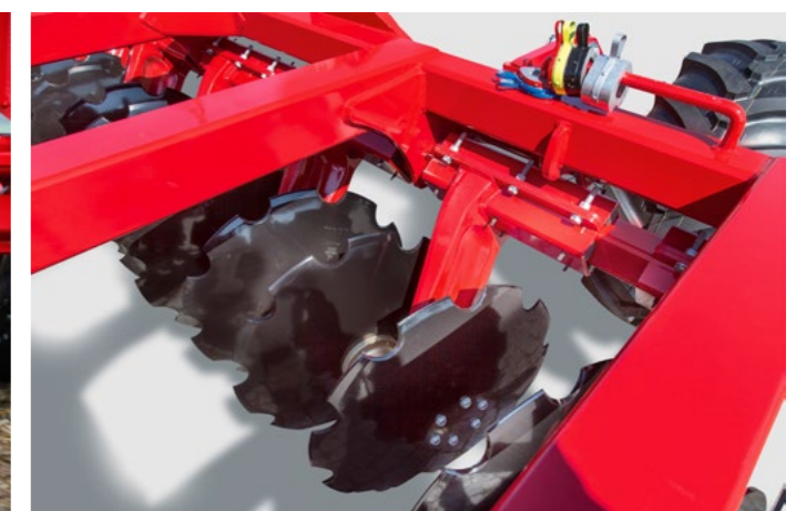
Discos de gran tamaño con un diámetro de 62 cm
