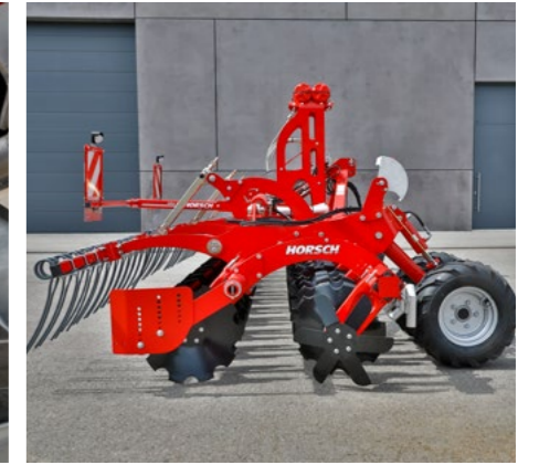
Aplicación de purines sin rodillo, con rastra para minimizar la susceptibilidad a obstrucciones
