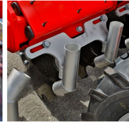
Salidas de purines de acero inoxidable para máxima durabilidad
