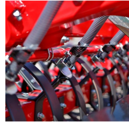
Barra de siembra para la siembra de cultivos intermedios en una sola pasada
