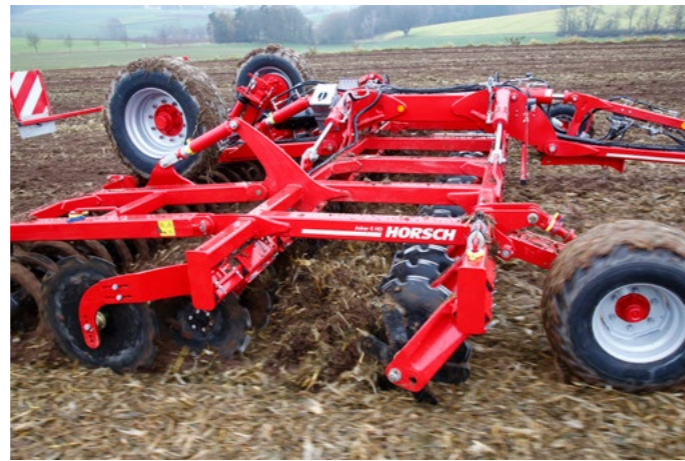
Gran distancia entre discos para un paso máximo en la máquina
