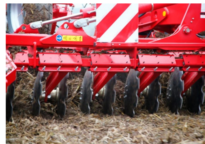
Amplio soporte de discos en el marco para una guía precisa de los discos en el suelo.
