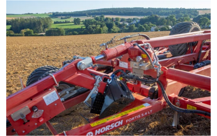
Transferencia de carga integrada al eje trasero del tractor sin puntos de acoplamiento adicionales
