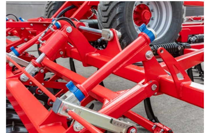
Ajuste del ángulo del compactador doble para poder reaccionar rápidamente a las condiciones cambiantes
