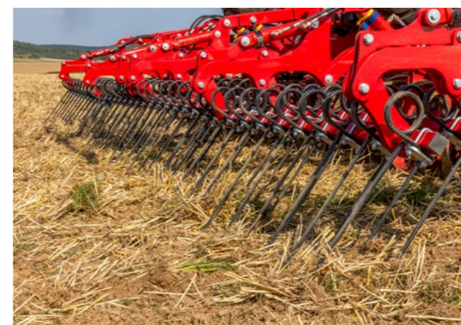
La rastra deposita las malas hierbas desraizadas en la superficie
