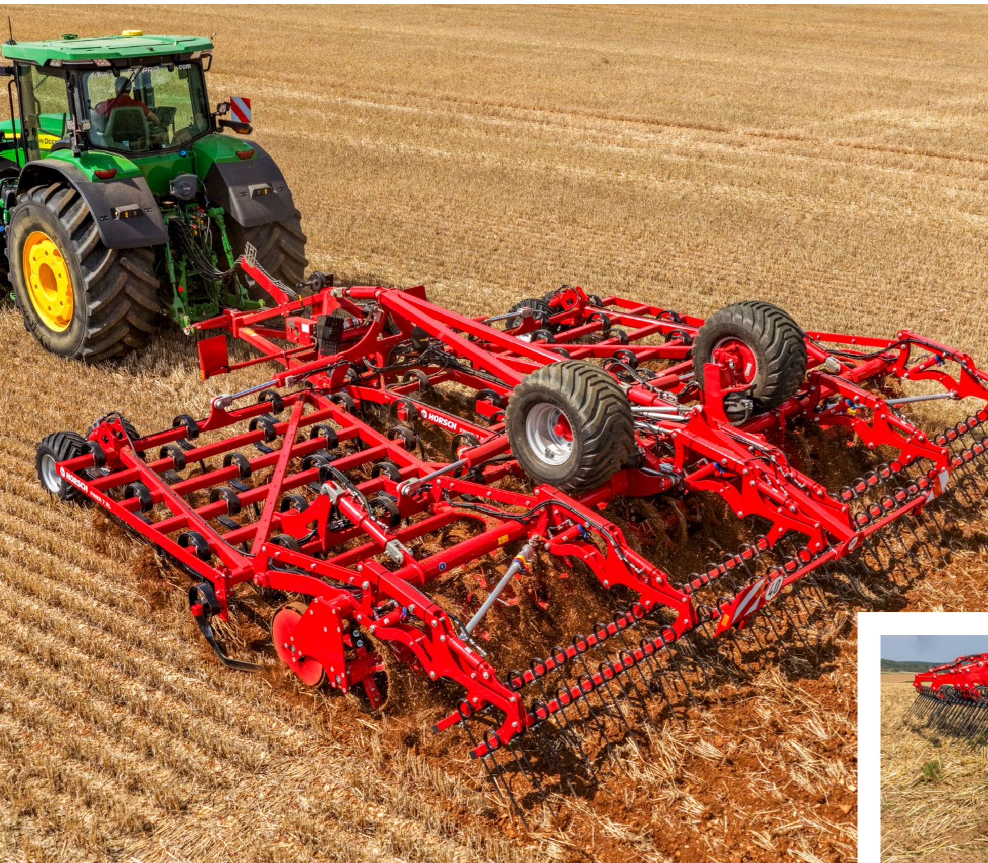
La rastra deposita las malas hierbas desraizadas en la superficie
