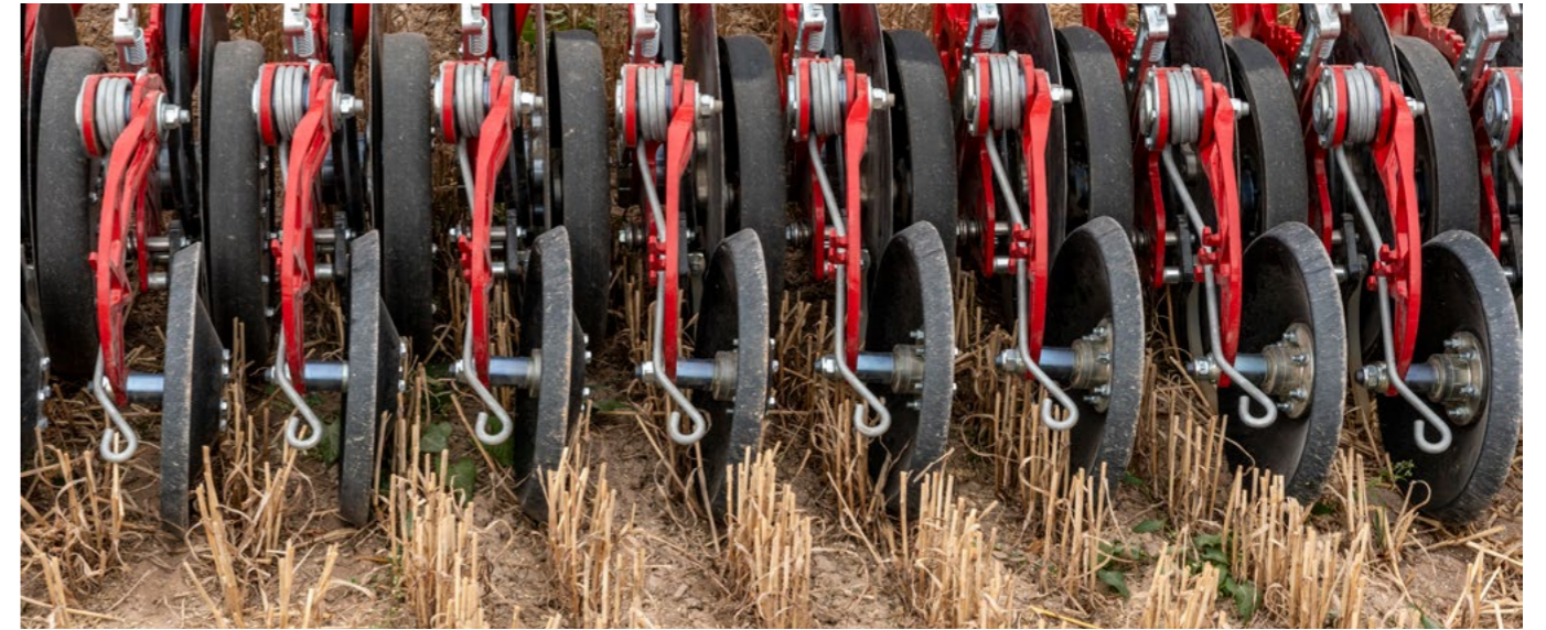
NarrowDisc reja de una sola hoja con 20 cm de distancia entre filas
