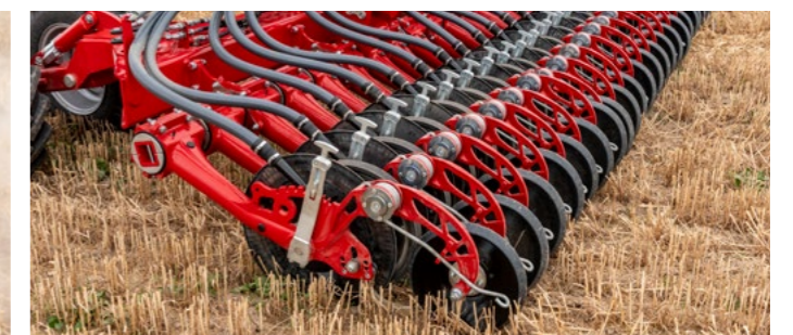
Disco de corte individual con guía de profundidad NarrowDisc
