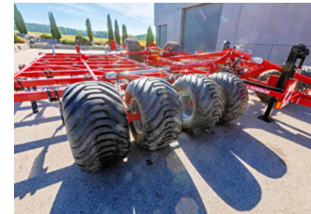
Wypożarty w 8 kół podporowych do zagęszczania przed całą maszyną
