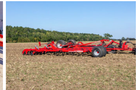
Środkowe koło podporowe zapewnia równomierne dopasowanie na wszystkich segmentach
