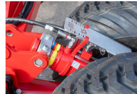
Hydrauliczna regulacja głębokości roboczej ze skalą
