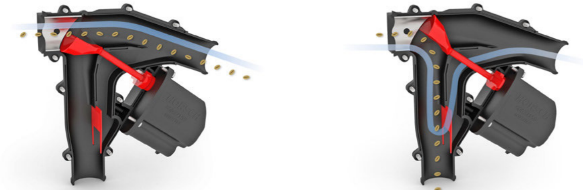
Клапан RowControl открыт: семена подаются в сошник
