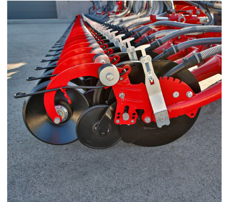
Превосходная фиксация семян благодаря прорезиненному улавливающему ролику
