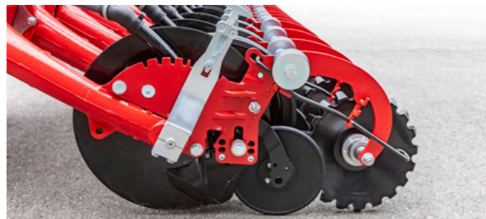
Стальные ролики-звездочки обеспечивают формирование мелкокомковатой структуры почвы и заделку борозды
