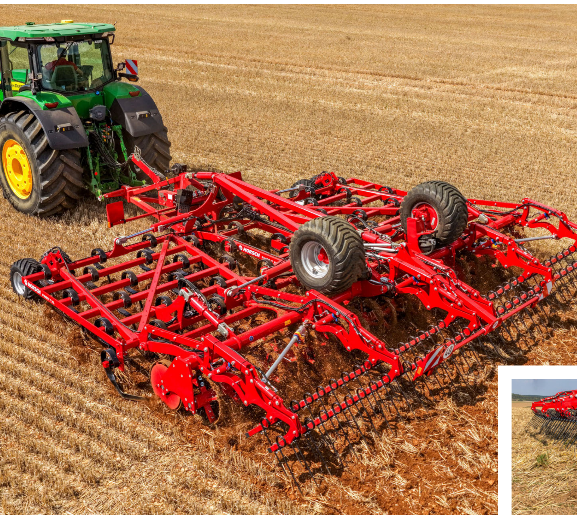
Штригельная борона оставляет вычесанные сорняки лежать на поверхности
