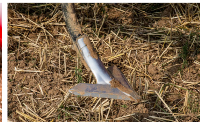
Стрельчатая лапа 22 см для сплошного реза
