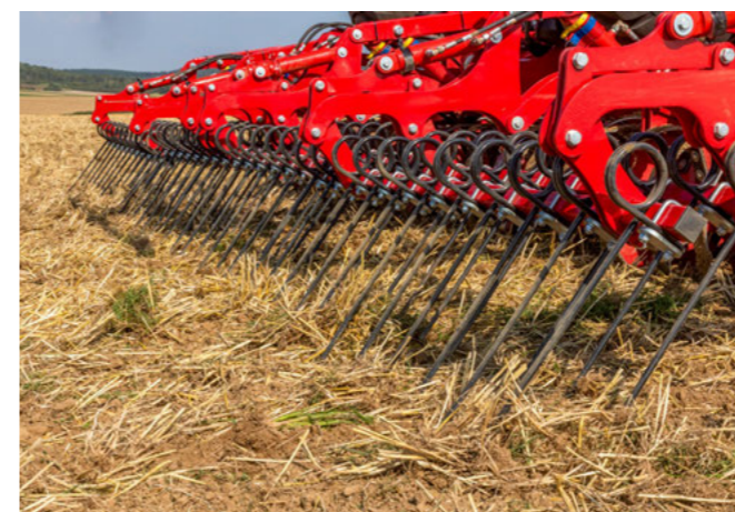
Штригельная борона оставляет вычесанные сорняки лежать на поверхности
