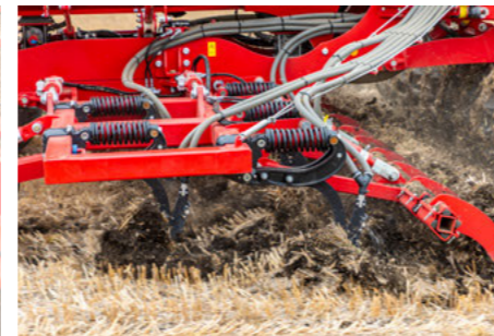
Лапы LD/LD Plus: перемешивание разрыхленного слоя
