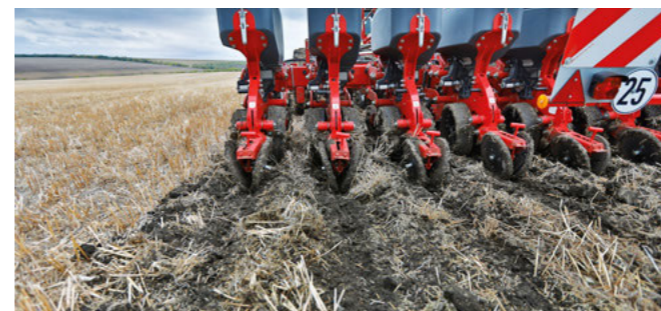
Обработка StripTill с последующим точным высевом
