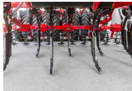
Лапа ULD не поднимает влагу из глубины
