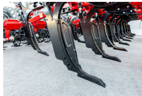
Лапа ULD обеспечивает рыхление без перемешивания почвы
