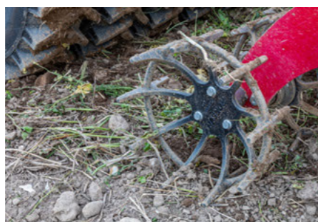
Focus TD: крошение комковатой почвы
