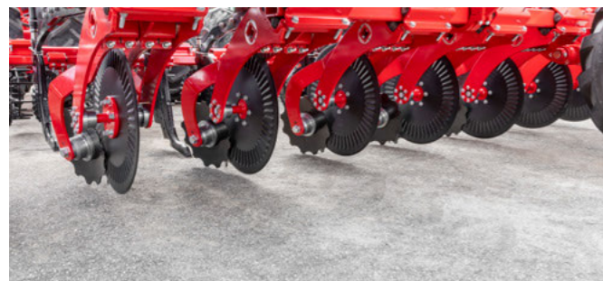
Расположение режущих дисков в один ряд
