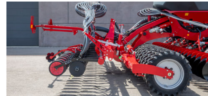
Однорядный шинный каток для равномерного обратного уплотнения почвы
