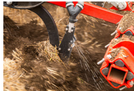
Лапы LD/LD Plus: внесение удобрений в верхний горизонт почвы
