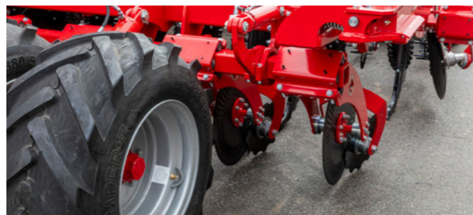
Прорезка непосредственно перед каждой стойкой
