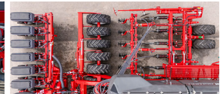
Шинный каток непосредственно за стойками для рыхления
