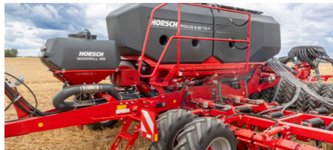
MiniDrill G&F для внесения третьего компонента
