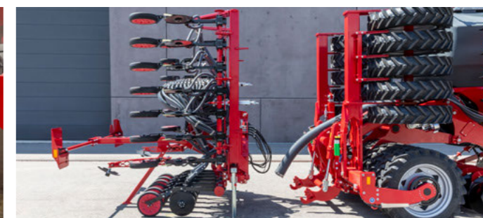
Простая замена высевальных секций благодаря трехточечной навеске
