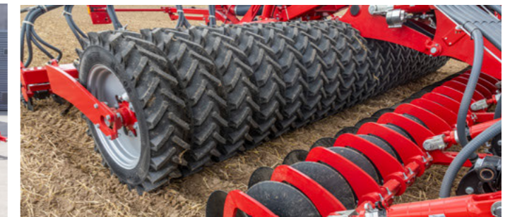
Однорядный шинный каток для равномерного обратного уплотнения
