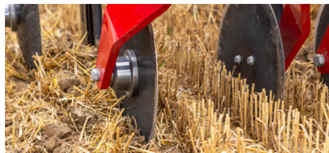
Предварительная резка почвы и органических остатков
