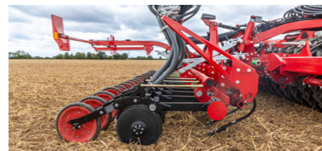
SeedFrame с сошниками ParaDisc (междурядья 30 см), выравнивающая доска и распределитель RowControl
