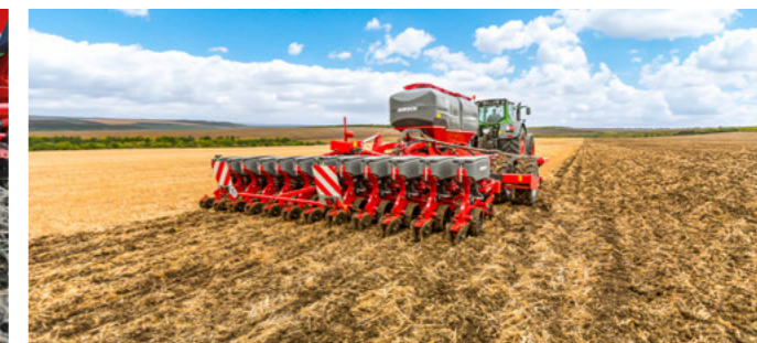
Focus TD с 3-точечной навеской в комбинации с Maestro RV (опция)
