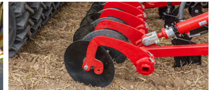
Выравнивающие диски для надежного закрытия разрыхленной полосы
