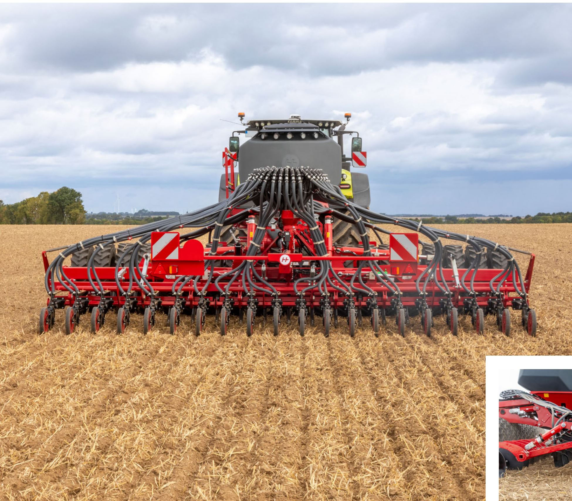
Focus — глубокое рыхление с одновременным депонированием удобрений
