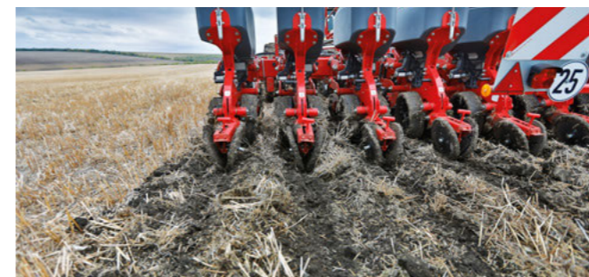
Обработка StripTill с последующим точным высевом
