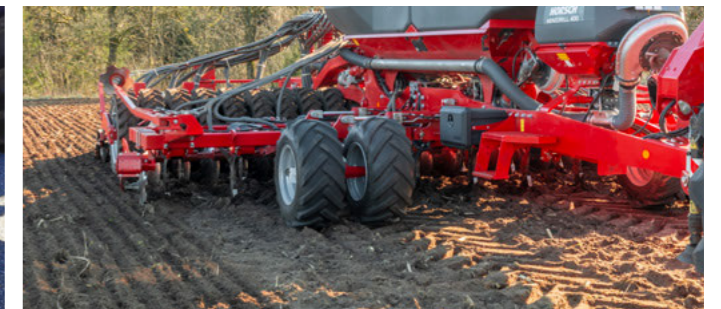
MiniDrill PPF: внесение третьего компонента в другой горизонт
