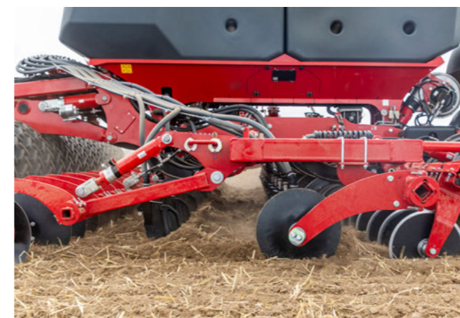
Focus — глубокое рыхление с одновременным депонированием удобрений
