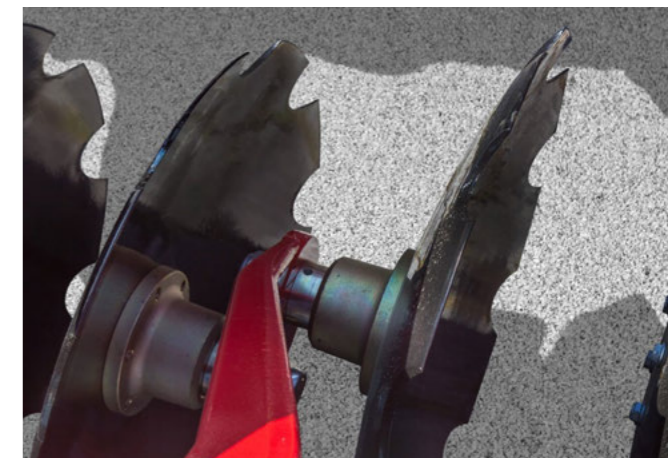
Вырезной диск диаметром 62 см
