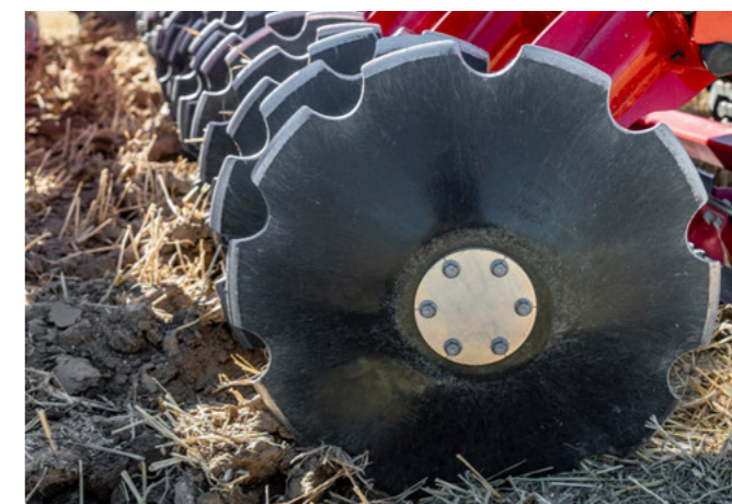
Вырезной диск диаметром 68 см
