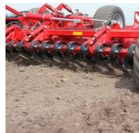
Выравнивающая доска для дополнительного разравнивания (опция)
