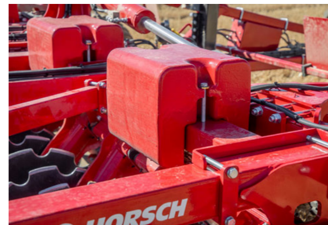
Дополнительный балласт для оптимального распределения веса и уверенного проникновения рабочих органов в почву
