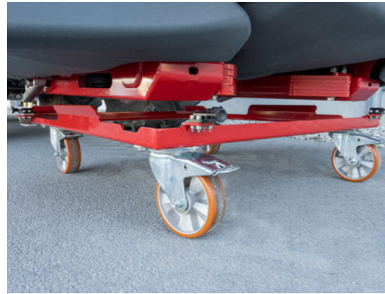
Прочная маневровая тележка упрощает манипуляции с фронтальным бункером
