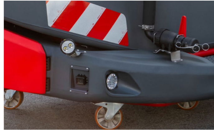
Светодиодные рабочие фары для освещения пространства перед машиной
