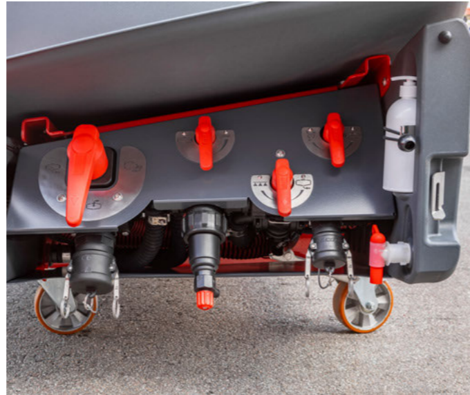
Жидкостная система с гидравлическим насосом и ручными многоходовыми кранами
