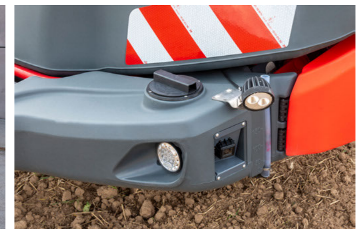
Бак для пресной воды с системой камер и передним освещением
