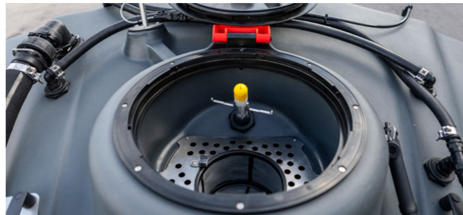
Функция очистки купольной части с промывкой резервуара
