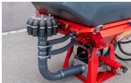
Распределитель с количеством выходов до 24
