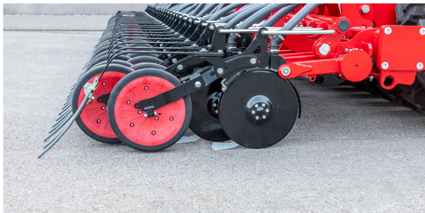
ParaDisc: давление до 150 кг на сошник
