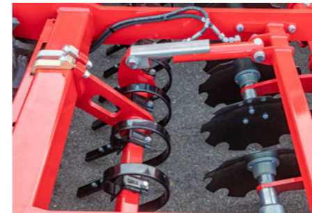
Однорядная выравнивающая доска, расположенная непосредственно за системой дисков DiscSystem, регулируется гидравлически.
