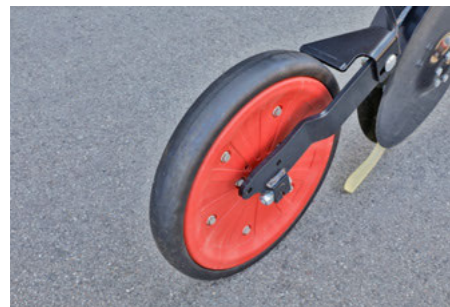
Прикатывающий ролик шириной 5 см идеально подходит для средних и тяжелых почв
