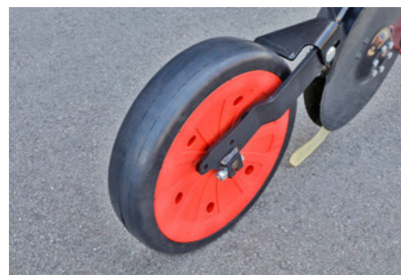
Сошник ParaDisc с прикатывающим роликом шириной 7 см
