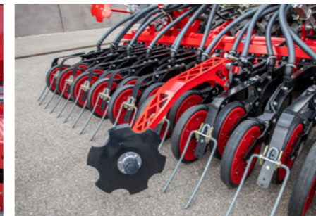
Агрессивность предвсходового маркера регулируется с помощью ограничителя глубины
