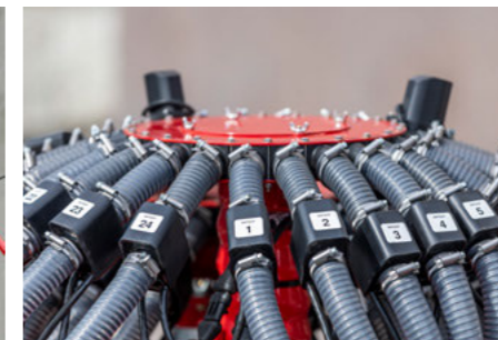
Пневматическая система для посева спелты (для семенного материала с шелухой)
