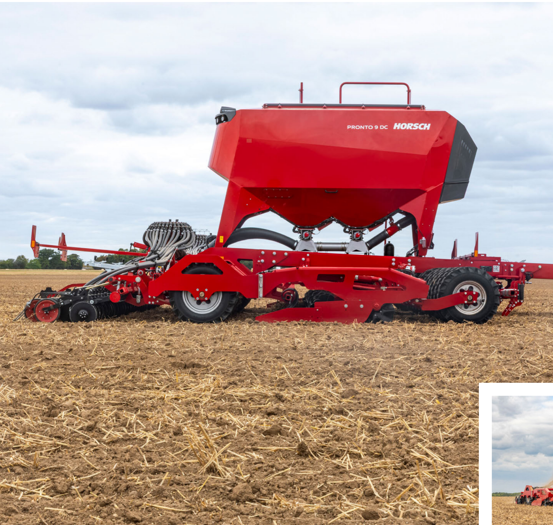
Стойки для рыления уплотненной почвы от колес трактора
