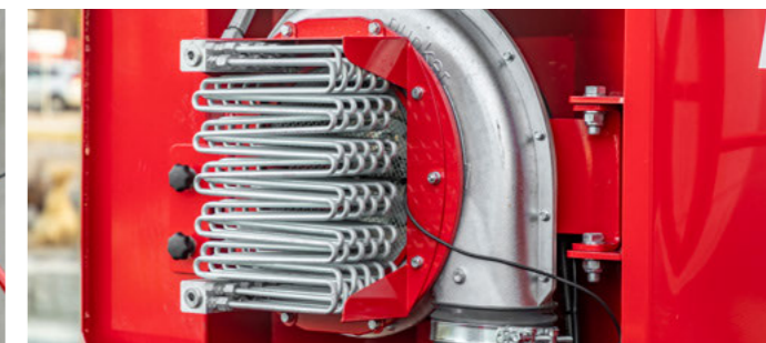
Снижает температуру масла в системе и уменьшает нагрузку на масляный радиатор трактора
