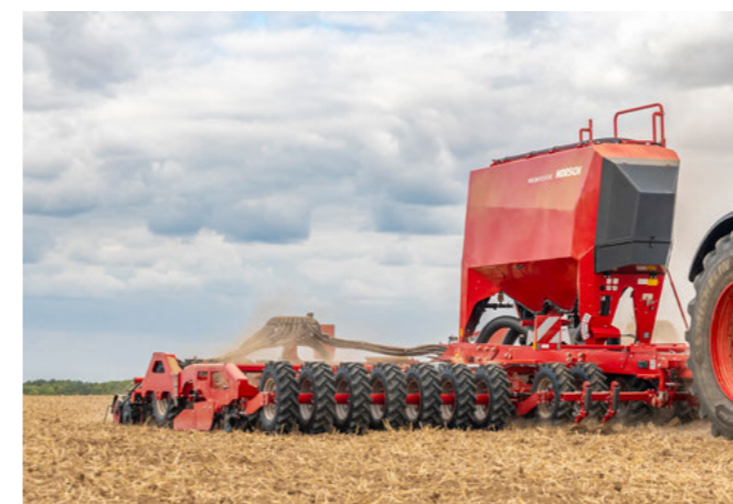
Стойки для рыления уплотненной почвы от колес трактора
