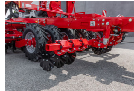
Диски для рыхления колеи используются для рыхления уплотненной почвы в колеях от колес трактора
