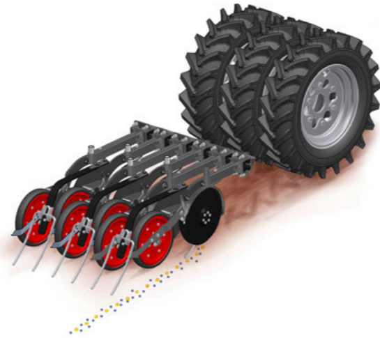
Двухсекционный бункер для семян и удобрений (G&F): совместная заделка двух компонентов через сошник TurboDisc
