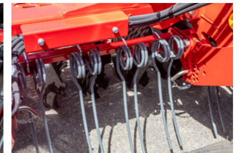
Штригальная борона устанавливается между DiscSystem и шинным катком. Регулировка осуществляется механически за счет специальных отверстий.
