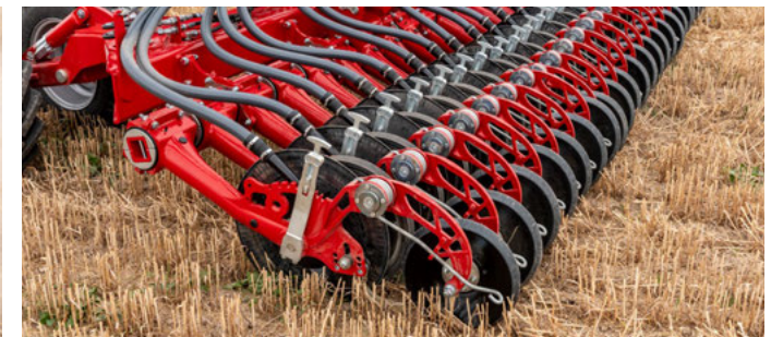
Prowadzona indywidualnie na głębokości jednotalerzowa redlica NarrowDisc
