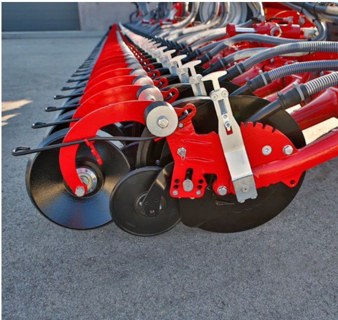
Idealne unieruchamianie nasion dzięki ogumowanej rolce chwytającej
