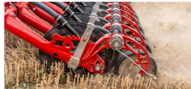
1-belkowa budowa zapewnia równomierne umieszczanie nasion
