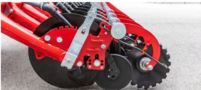
Rolka gwiazdzista ze stali – wytwarza drobnogruzelkową glebę i zamyka brzdę siewną
