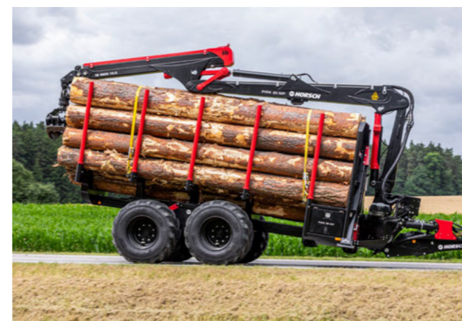
Snížením až na doraz je oj zajištěna proti bočnímu posunu
