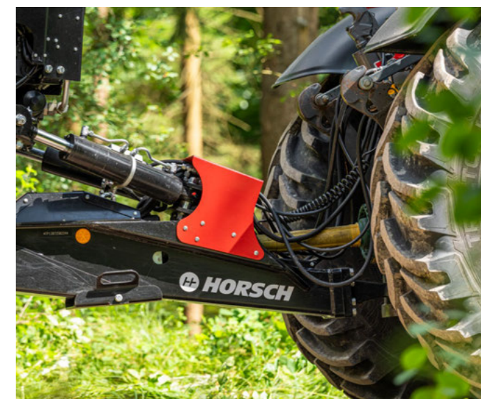
V oji chráněně vestavěné čerpadlo poháněné vývodovou hřídelí pro pohon palubní hydrauliky
