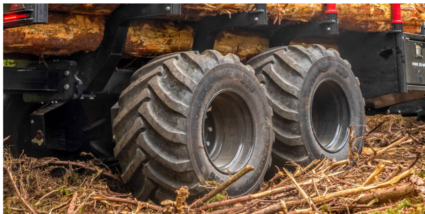
Výkyvné nápravy s rozsahem výkyvu až \pm 20^\circ
