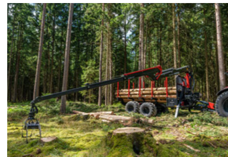
IB 9800.L10 s dosahem až 10 m a nosností 2,2 t při vyložení 4 m
