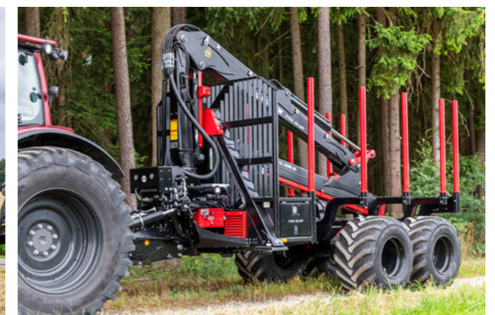
Na polních a lesních cestách je vůz zvednut pomocí hydraulické oje pro větší světlost výšku
