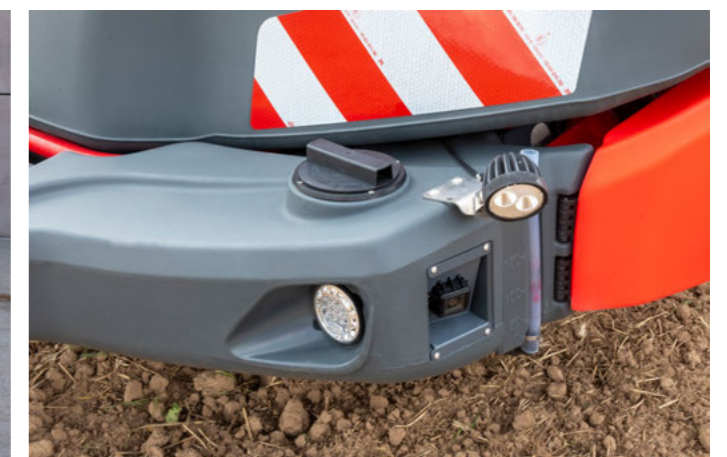
Резервуар для чистої води з системою камер і підсвічуванням передньої частини
