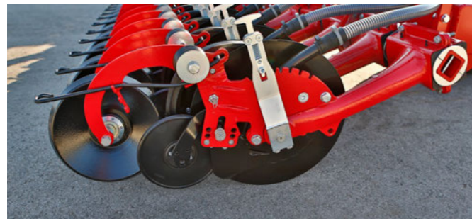
Ідеальне копіювання поверхні ґрунту сошником SingleDisc завдяки опорному колесу глибини
