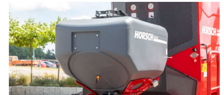
Можливість одночасного внесення до чотирьох компонентів з опцією MiniDrill на 400 л
