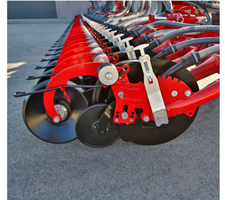
Ідеальна фіксація насінин завдяки гумовим вловлювальним колесам
