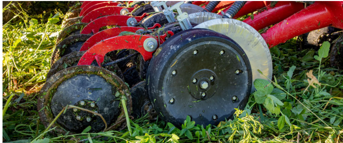
SingleDisc під час роботи у полі з великою кількістю пожнивних решток
