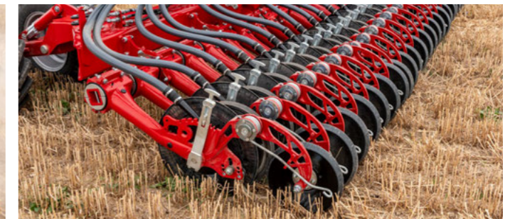
Однострижковий сошник NarrowDisc з незалежним веденням за глибиною
