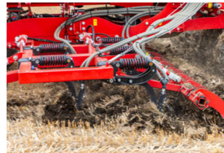
Лапи LD/LD Plus — перемішування спущеного ґрунту
