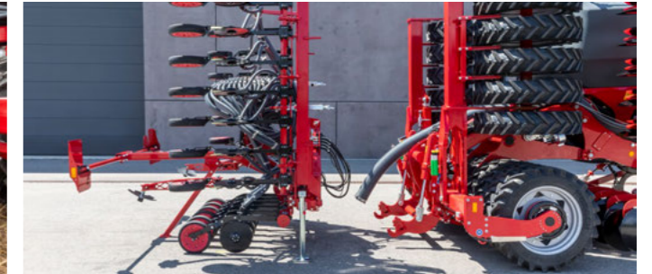
Проста зміна висівних шин завдяки 3-точковому кріпленню на бункері
