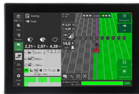
З HORSCH AutoLine на універсальних сівалках можна сіяти незалежно від ритму технологічних колій
