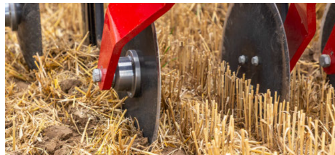
Подрібнення органічних решток і розрізання поверхні ґрунту
