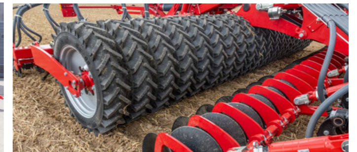
1-рядний коток для рівномірного ущільнення ґрунту
