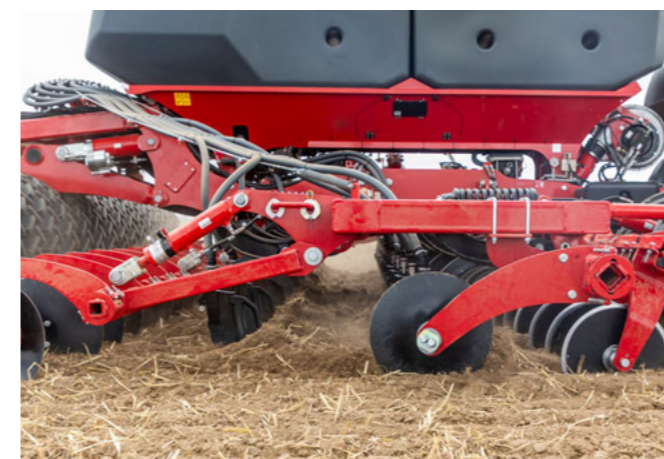
Глибоке розпушування ґрунту з одночасним закладенням депо добрив із Focus
