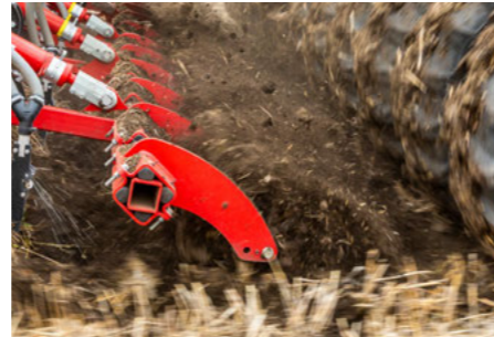
Подрібнення грудок спеціальними робочими органами (грудобоями)
