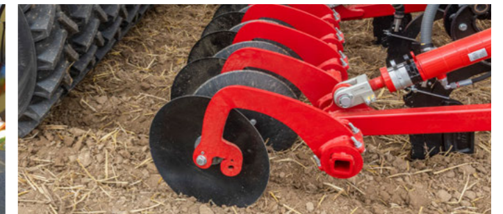
Вирівнювання поверхні за допомогою дисків для надійного закриття спущеної борозни
