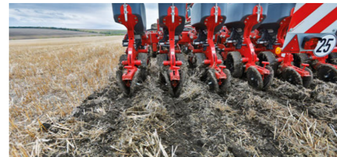
StripTill з точним висівом
