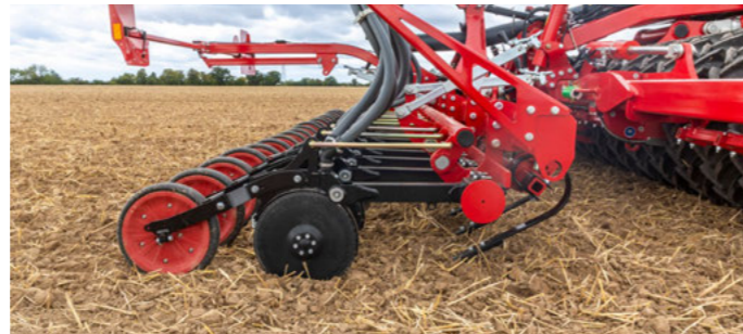
Crossbar для додаткового вирівнювання поверхні ґрунту
