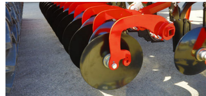
Вирівнювальні диски з універсальним застосуванням
