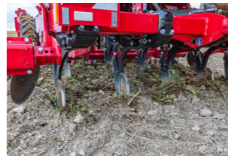
Лапа ULD відкриває рядок й вносить добрива
