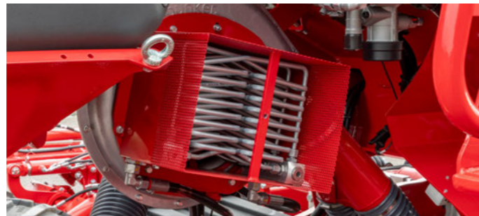
Система охолодження гідравлічного двигуна
