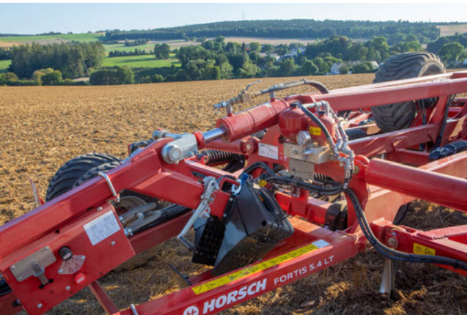
Zintegrowane przenoszenie obciążenia na tylną oś ciągnika bez dodatkowych punktów sprzęgu
