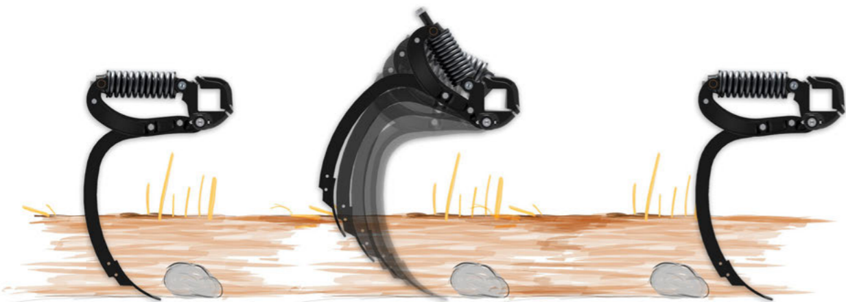
TerraGrip III - ефективне спрацювання захисту
