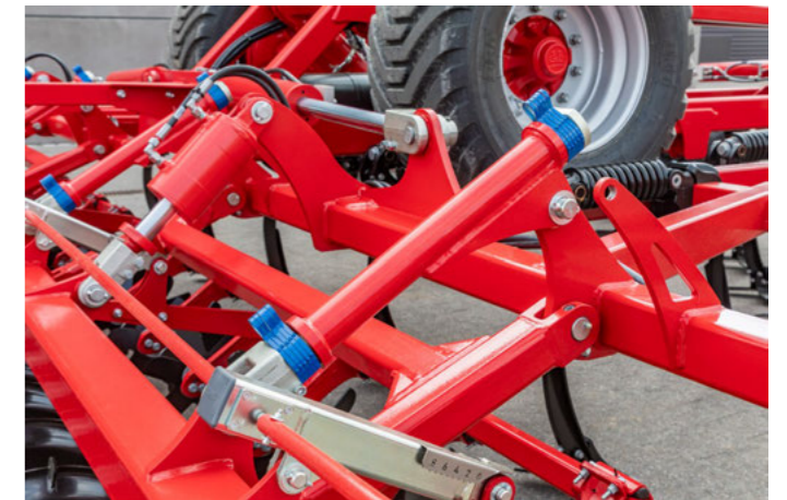
Регулювання кута нахилу котка для всіх подвійних котків, щоб швидко реагувати на змінні умови
