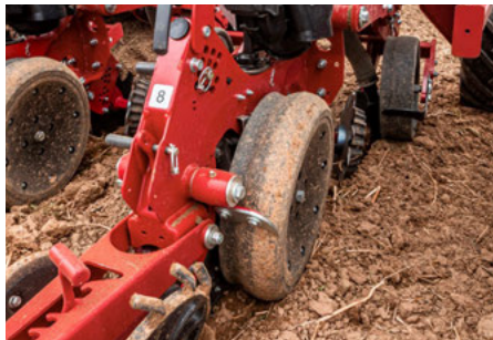
Koło RID zmniejsza ugniatanie gleby bezpośrednio przy szczelinie siewnej w bardzo trudnych warunkach lub w siewie bezpośrednim
