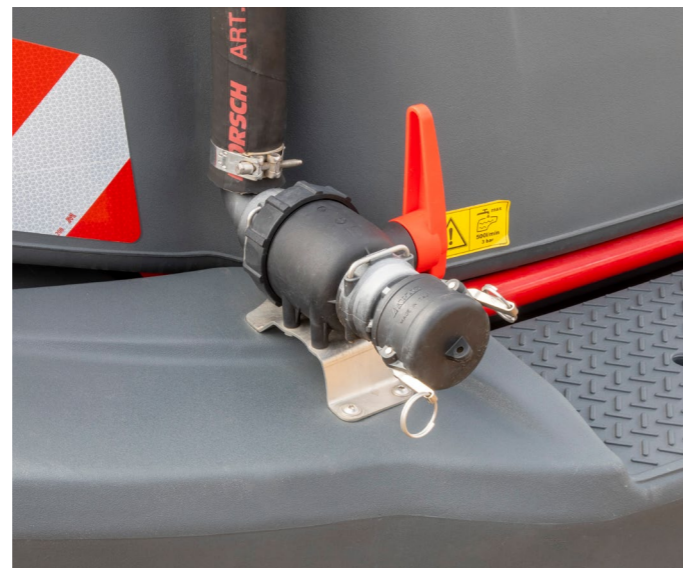
Wydajne zewnętrzne napełnianie z zewnątrz przyłączem 2"
