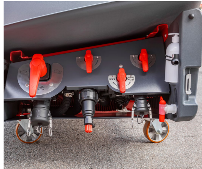
System wodny z pompą hydrauliczną i ręcznymi zaworami wielodrogowymi
