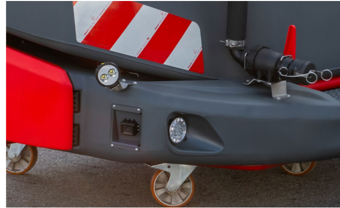
Reflektory robocze LED do oświetlenia przedpola
