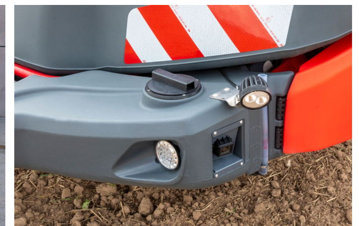
Zbiornik na czystą wodę z systemem kamer i oświetleniem przedpola
