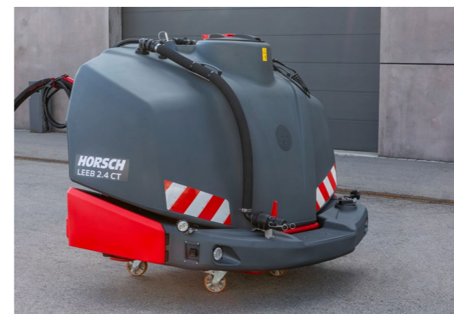
Niezależny przedni zbiornik do współpracy z maszynami zawieszanymi z zakresu pielęgnacji upraw, siewu oraz rolnictwa hybrydowego
