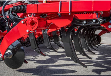
Redlica LD/Redlica LD Plus – znaczny efekt mieszania
