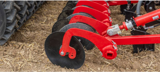
Wyrównanie talerzami w celu pewnego zamknięcia spulchnionego pasa.
