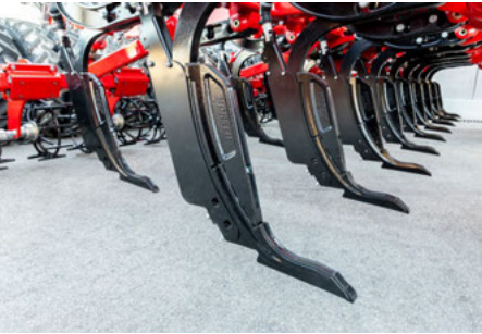
Redlica ULD spulchnia glebę, nie mieszając jej
