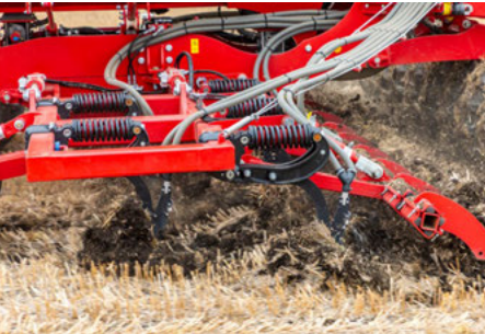
Redlica LD/Redlica LD Plus – mieszanie spulchnionej przestrzeni
