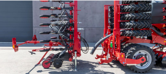
Łatwa wymiana szyny siewnej dzięki zawieszeniu na TUZ-ie
