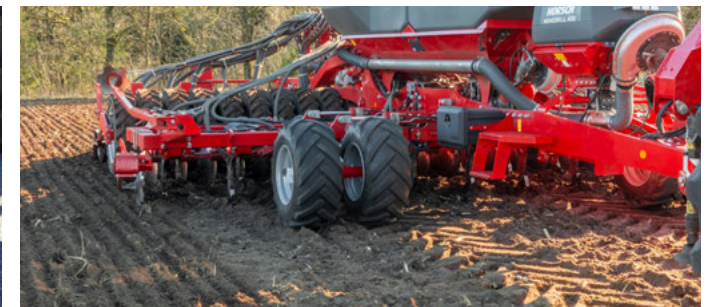
MiniDrill PPF – można wysiewać trzeci składnik na dodatkowej powierzchni
