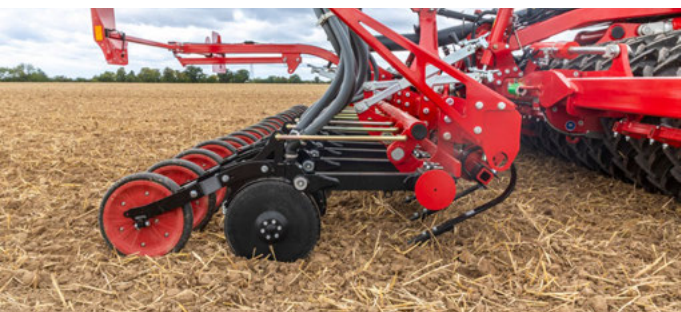
Szywa niwelująca Crossbar do wtórnego równania powierzchni gleby.
