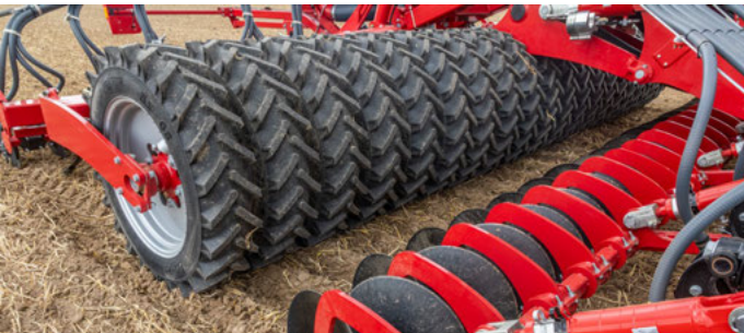
1-rzędowy wał oponowy zapewnia równomierne wtórne zagęszczanie gleby
