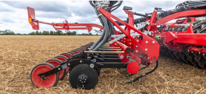
SeedFrame z redlicami ParaDisc co 30 cm, belka niwelująca Crossbar oraz głowica rozdzielacza RowControl
