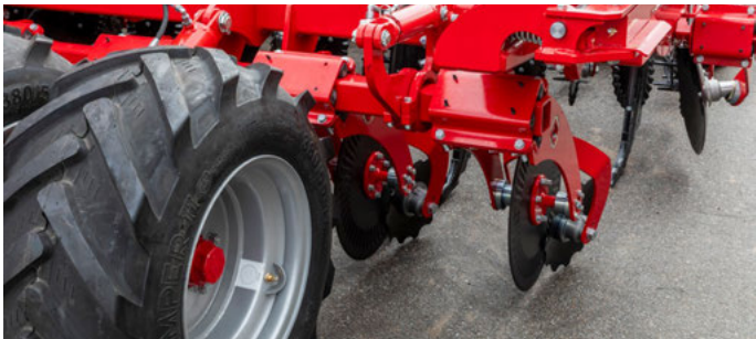
Wstępne cięcie bezpośrednio przed każdym zębem
