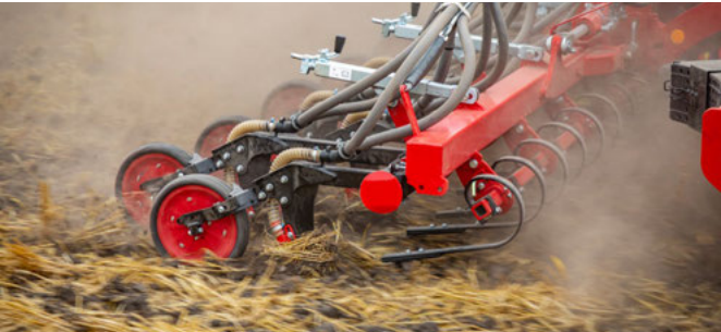
Szyna siewna SeedFrame z redlicą zębową TurboEdge
