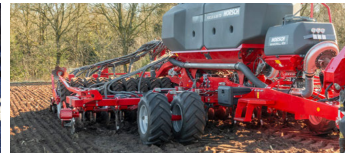
MiniDrill PPF – można wysiewać trzeci składnik na dodatkowej powierzchni
