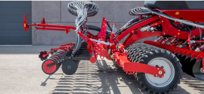
1-rzędowy wał oponowy zapewnia równomierne zagęszczania gleby
