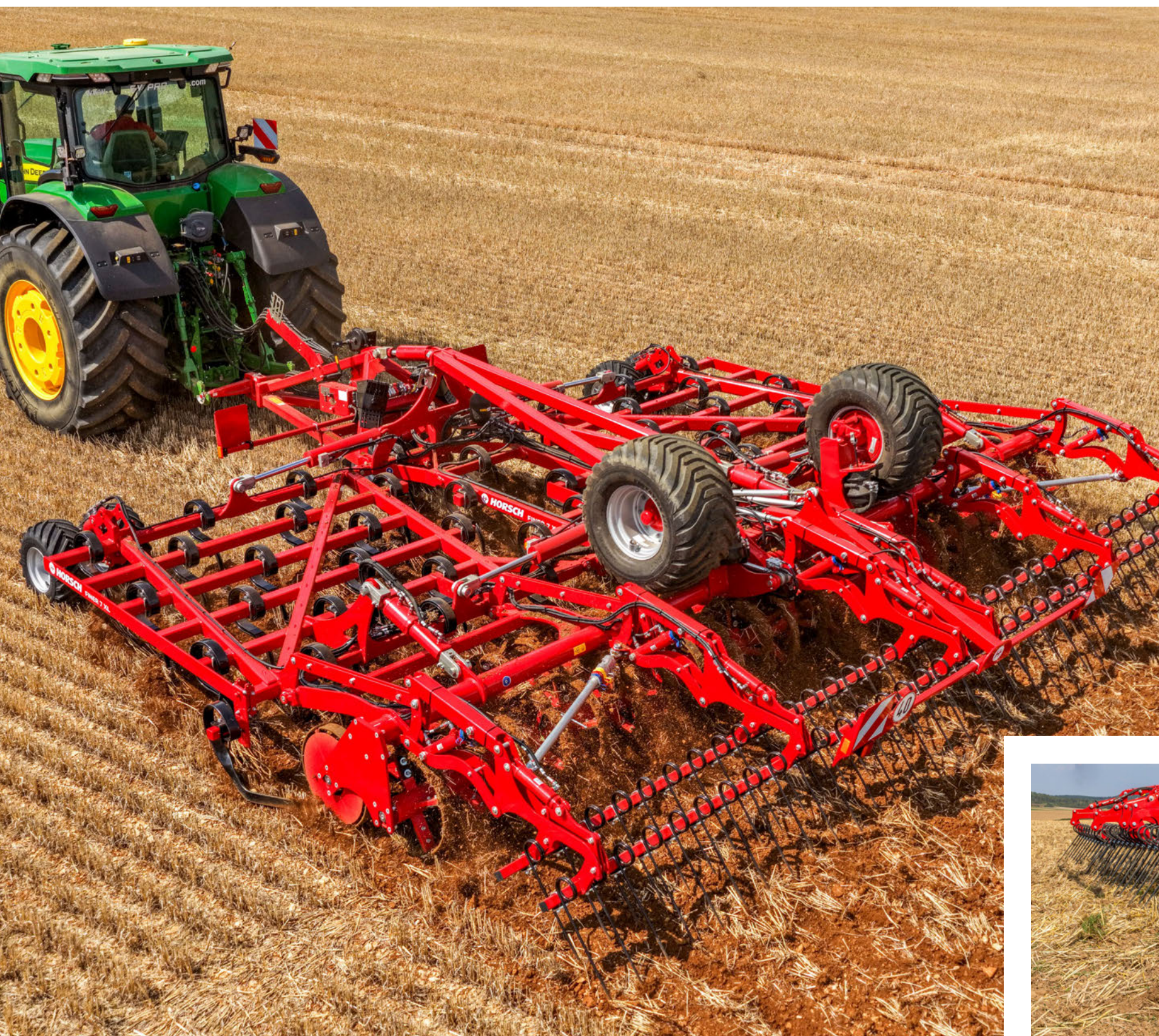
Brona zgrzebło wyciąga korzenie chwastów na powierzchnię gleby
