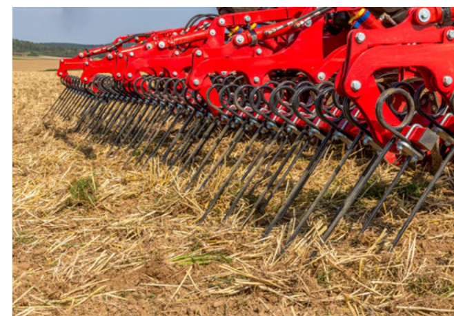
Brona zgrzebło wyciąga korzenie chwastów na powierzchnię gleby
