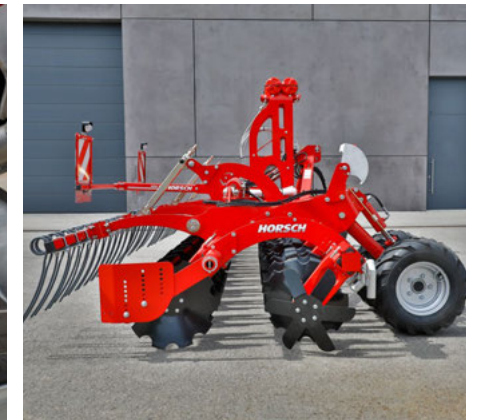
Wersja aplikacji gnojowicy bez wału z broną zgrzebło zapewnia minimalną podatność na zatykanie
