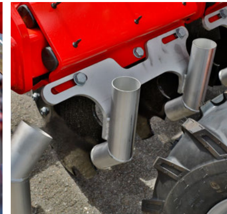
Wyloty gnojowicy ze stali nierdzewnej zapewniające maksymalną trwałość
