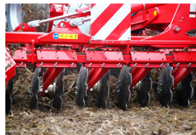
Szerokie łożyskowanie talerzy na ramie zapewnia dokładne ich prowadzenie w glebie
