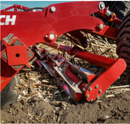
Opcjonalnie z hydraulicznie napiętym wałem nożowym zapewniającym dodatkowy efekt rozdrabniania.
