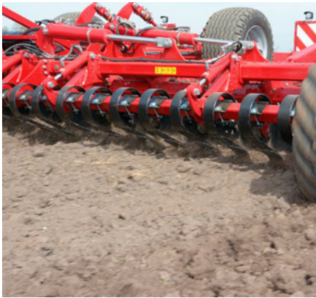
Opcjonalnie z szyną Crossbar daje dodatkowy efekt wyrównywania
