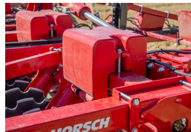
Dodatkowe obciążenia zapewniające optymalny rozkład ciężaru i pewne wnikanie w glebę
