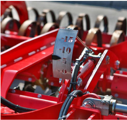
Hydrauliczna regulacja głębokości zapewnia wygodne ustawienie maszyny
