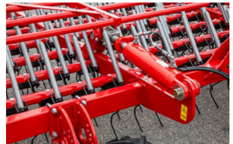
Schwerpunkt der Maschine wird nah am Traktor gehalten
